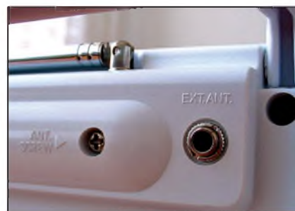
Obr. 4. Vstup pro externí anténu a upevnění teleskopické antény
