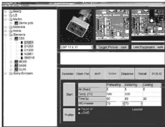
Obr. 2: Výběr pájecí trysky, DPS a zobrazená pozice
