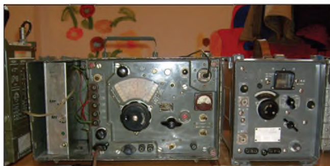
Obr. 5. Sovětský KV přijímač R311 (vlevo, rozsah 1 až 15 MHz v pěti podrozsazích, napájení 2,4 V z vnitřní baterie, druhy provozu A1, A3) a VKV přijímač R323 (vpravo, rozsah 20 až 100 MHz, druhy provozu A1, A3, F3)
