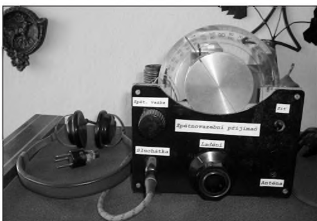
Obr. 9. (Vlevo) Přijímač autora tohoto příspěvku (-jse-) s elektronkou AF7
