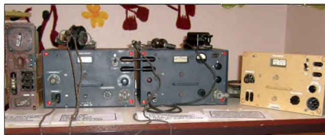
Obr. 4. Německá válečná radiostanice, používaná dělostřelectvem, typu Feld Fu.b pro pásmo 90 až 110 MHz, s výkonem 0,15 W a dosahem 1,2 km
