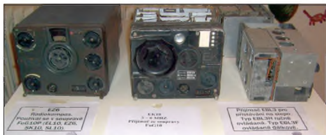
Obr. 3. Přístroje z německé válečné rádiové letecké soupravy FuG. Zleva radiokompas EZ6, přijímač E10K (3 až 6 MHz) a přijímač EBL3 pro přistávání naslepo
