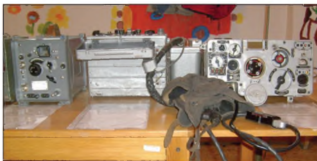
Obr. 6. Sovětská VKV radiostanice R123M, používaná v 60. letech v tancích a obrněných transportérech; druh provozu F3, rozsah 20 až 51,5 MHz, výkon 20 W, napájení 26 V z palubní sítě, dosah asi 28 km
