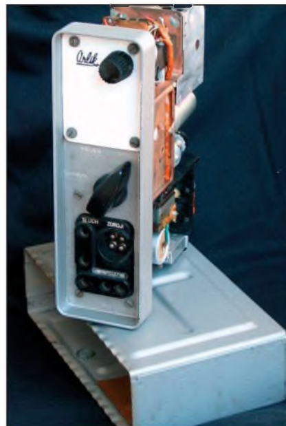
Obr. 1. Pohled na přední panel radio-stanice Orlík
