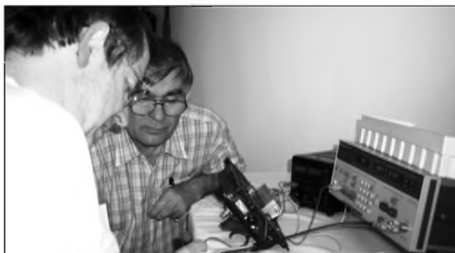
Obr. 2. František Strihavka, OK1CA (vlevo), měří šumové číslo předzesilovače Janovi, OK8ID
