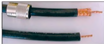
Obr. 2. Příprava koaxiálního kabelu k montáži konektoru
