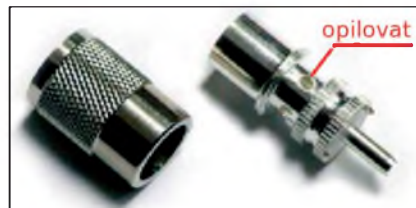
Obr. 3. Příprava těla konektoru k montáži. Okolí otvorů v dílku konektoru je nutné příčně opílovat jehlovým pilníkem
