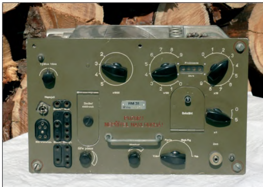
Obr. 2, 3. Samostatný anténní člen k RM-31, pohled na čelní panel a vnitřní uspořádání (dole)
