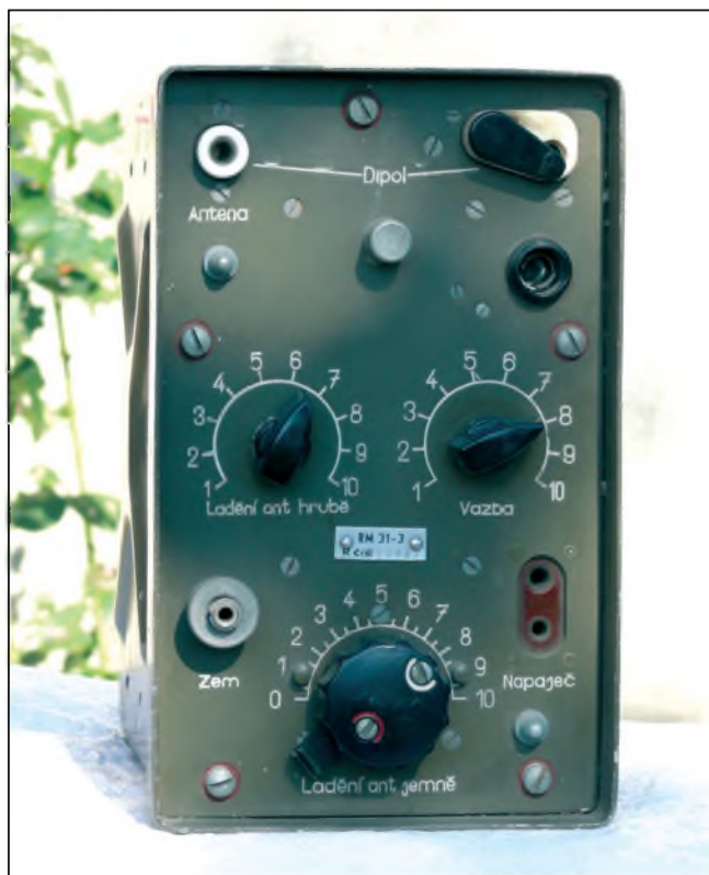
Obr. 2, 3. Samostatný anténní člen k RM-31, pohled na čelní panel a vnitřní uspořádání (dole)
