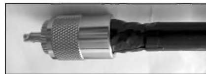
Obr. 6 až 9. Názorný postup při trubičkování konektoru
