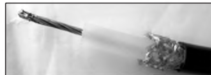
Obr. 5 a) Sestava „trubičkového“ konektoru; b) sestava v řezu, znázorňující připájení kabelu. PE dielektrikum je naraženo až do konce těla konektoru, opletení přetaženo přes konec trubičky a je k ní připájeno po celém obvodu
