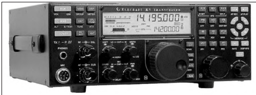
Obr. 1. Pohled na čelní panel transceiveru Elecraft K3
