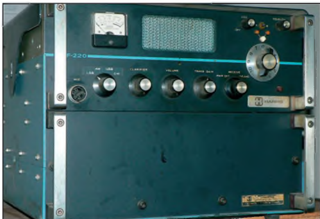
Obr. 15. transceiver Harris RF-220 so zdrojom (vľavo)
