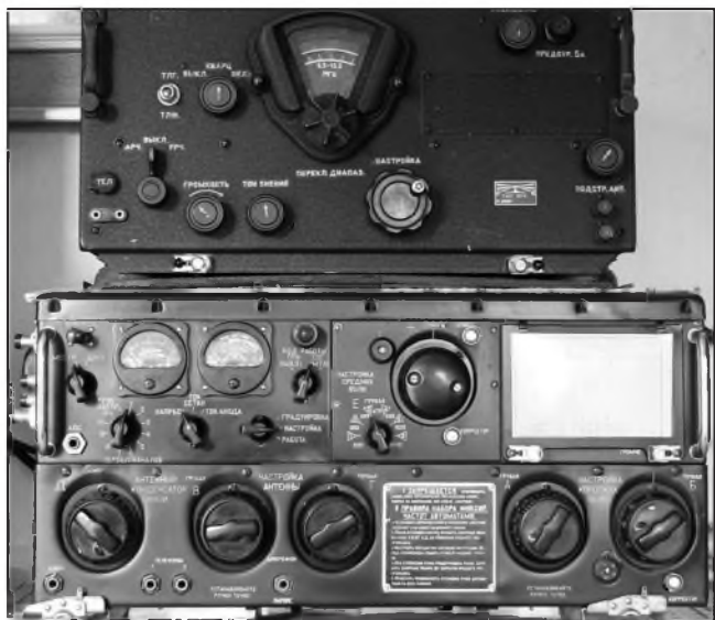
Obr. 12. Rádiostanica RSB70 (dole) s prijímačom US9 (hore)
