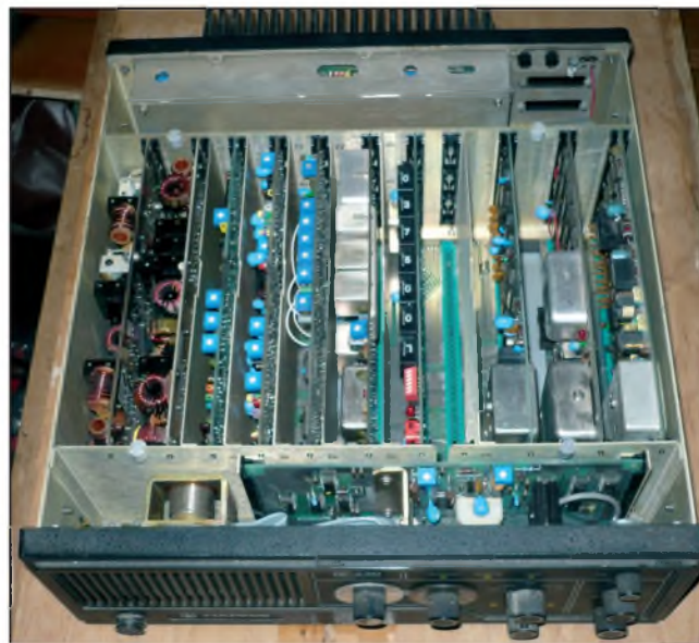
Obr. 15. transceiver Harris RF-220 so zdrojom (vľavo)
