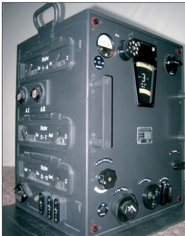
Obr. 1, 2. Přijímač Schwabenland, pohled z obou stran, s nastaveným třetím rozsahem. Na levém boku jsou dvířka, za kterými jsou dostupné elektronky, dole je přívod sítě, zdířky sluchátek, telefonní linky a antény. Na přední straně je kontrolní voltmetr a ovládací prvky, ladění, přepínání rozsahů, šíře pásma, přepínač funkcí, druhy provozu (foto TNX DJ0AK)
