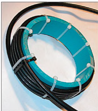
Obr. 1. Jednovrstvové vinutí tlumivkového balunu z koaxiálního kabelu. Závity jsou ke kostře upevněny pomocí polyetylenových vázacích (stahovacích) pásků. Balun nebyl ničím natírán, lepen ani impregnován. Tato technika vinutí byla použita pro první čtyři baluny (tab. 1), které dosahují velmi zajímavých parametrů
