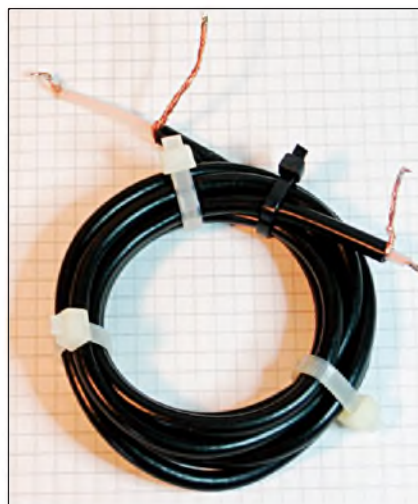
Obr. 2. Nejběžnější technika vinutí tlumivkových balunů z koaxiálního kabelu. Z výsledků měření vyplývá, že takto vinutý balun vykazuje ze všech měřených prototypů nejhorší vlastnosti, a proto lze jen doporučit vinutí v jedné vrstvě dle předcházejícího obrázku
