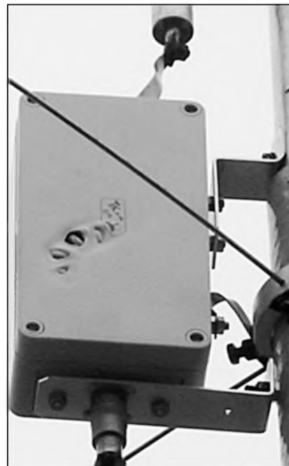
Obr. 13. Přehřátý balun může protavit i plastovou skříňku, ve které je umístěn
