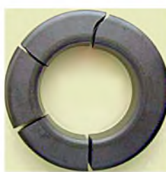
Obr. 11. Feritové jádro FT240-61, roztržené prudkým ohřátím
