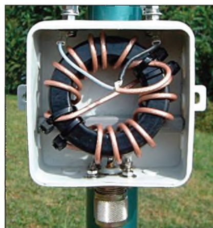
Obr. 15. Praktické provedení balunu s vinutím podle W1JR - 2 x 7 závit teflonového kabelu RG-174 na toroidu Amidon FT240-61 (ztráty 0,3 dB na všech KV pásmech [Brian, KF2YN])
