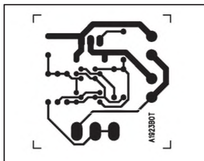
Obr. 3. Obrazec desky spojů stmívače
