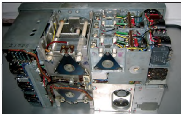
Obr. 7. Zadní strana přijímače Mw.E.c. Nahoře, téměř uprostřed, je prázdná komůrka po ladícím kondenzátoru „121a“, vpravo dva duální šíře přijímaného pásma, více vpravo vstupní vf elektrony, dole vpravo BFO a nf koncový stupeň
