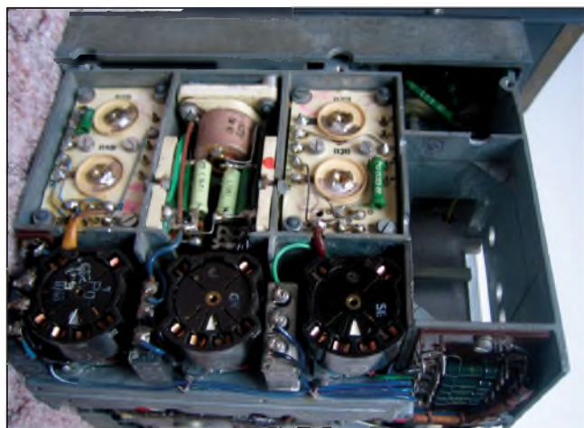
Obr. 5. Záběr vstupních oscilátorových obvodů, vývodů cívek s trimry, které jsou integrovány na keramických polévaných destičkách. Ochranné kryty jsou sejmuty. Vpravo je uvolněná komůrka - po roce 1942 - určená pro obvod L/C anténního vstupního obvodu
