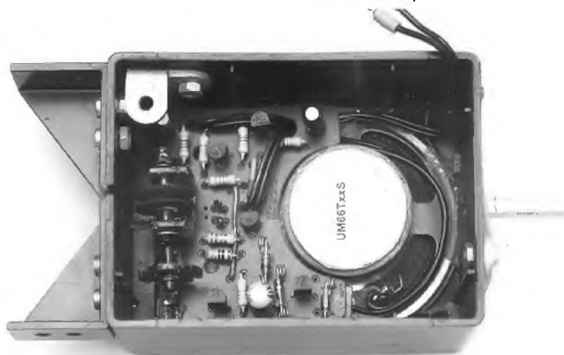
Obr. 57, 58. Deska s plošnými spoji a rozmístění součástek pro číhátko s UM66TxxS
