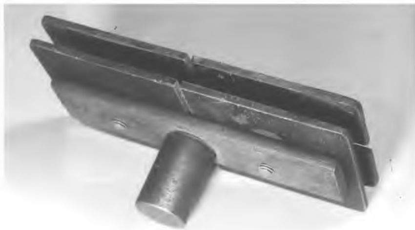
Obr. 14. Fotografie sestaveného navijecího přípravku
