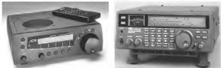
Obr. 57. Novinky na trhu - komunikační přijímače AR7030 (vlevo) a AR5000 (vpravo) s rozsahem 10 kHz až 2600 MHz (!)
