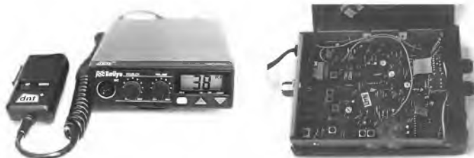
Obr. 9 Vnější a vnitřní provedení radiostanice DNT Rallye
