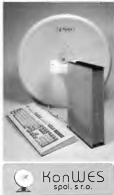
Mikrovlnná jednotka fy KonWES k propojení počítačových sítí (SARS-11)
