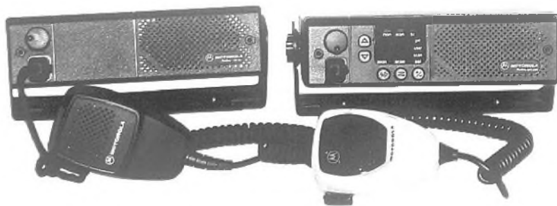
M10, M120, GM300 - radiostanice Motorola Radius M10 (vlevo), M120 a GM300 (vpravo) jsou již delší dobu nejuniverzálnější a nejprodávanější mobilní radiostanice pro konvenční radiové sítě v pásmech VHF i UHF. Lze je používat i v retranslační stanici nebo jako základnové. Jsou odolné proti stříkající vodě, prachu, šokům i otřesům. Výstupní výkon je programovatelný v mezích 10 až 25 W, hmotnost 1,7 kg
