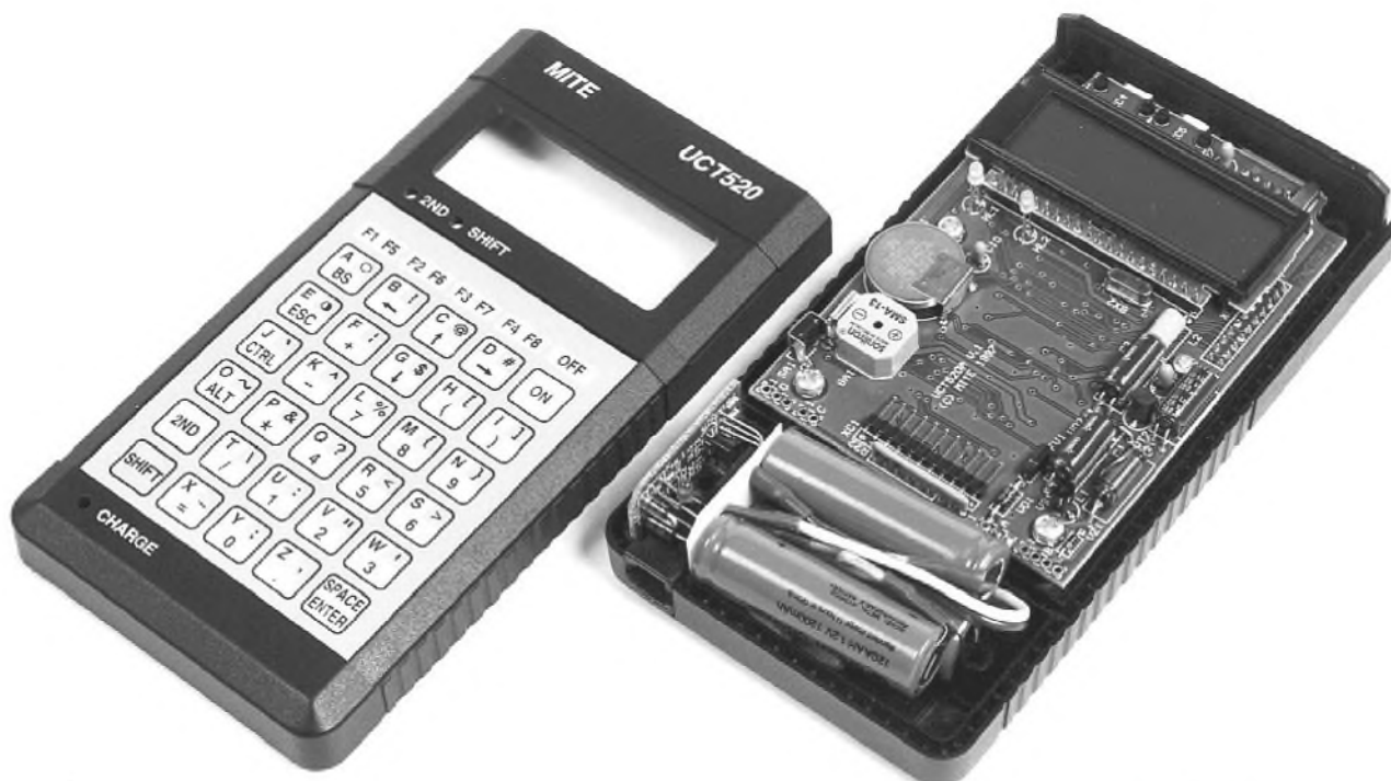
Obr. 2-2. Mikropočítač UCT520 s demontovanou horní polovinou pouzdra
