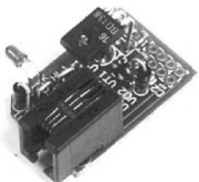
Obr. 4-1. Deska s plošnými spoji UCT520C
