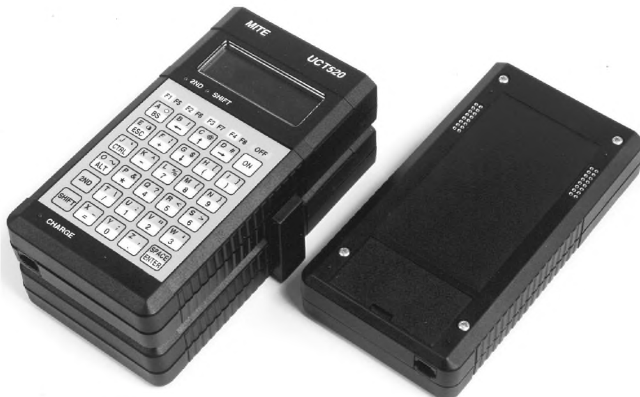
Obr. 2-5. Sestava mikropočítače UCT520 a přídavného modulu, provedení dolní stěny UCT520
