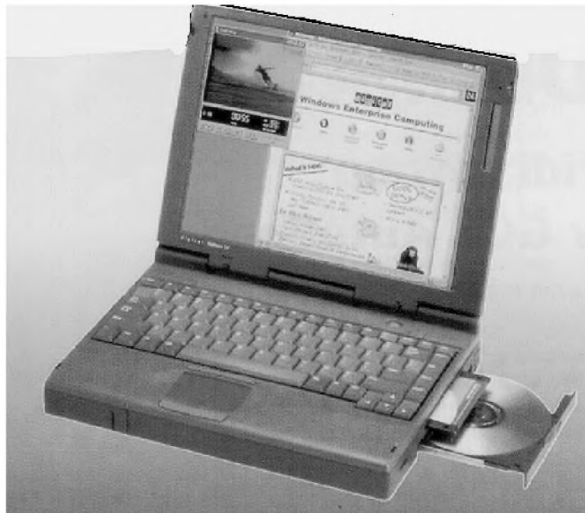
HiNote VP 500 MMX, procesor Pentium 120, popř. 133 MHz, popř. Pentium MMX 166 MHz, 256 KB cache, EDO RAM 16 MB rozšiřitelná na 80 MB, pasivní DSTN nebo aktivní TFT displej 12,1", pevný disk 1, 1,4, 2,1 MB uživatelsky výměnný, Windows 95, Windows NT 4.0, ClientWorks
