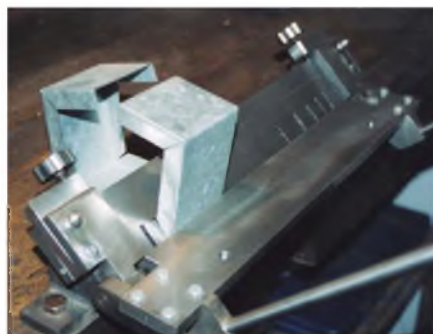
Obr. 4. Zářezy v horní liště, které umožňují ohýbat příčně profilovaný plech
