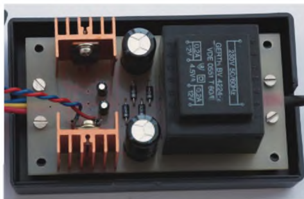
Obr. 3. Sítový adaptér se stabilizovaným výstupním napětím \pm 9\text{ V}
