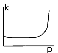
Obr. 48. Závislost zkraslení k na výstupním výkonu P
