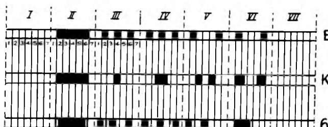
Návrh rozložení znaků E, K a 6 na jednotlivé body pro přenos
