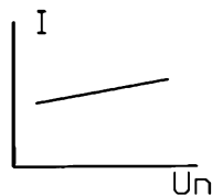
Obr. 45. Závislost klidového proudu I na napájecím napětí U_n
