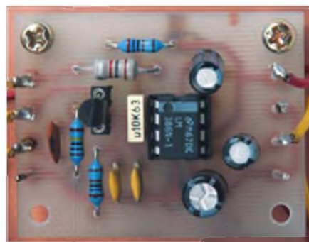
Osazená deska s plošnými spoji krátkovlnného zpětnovazebního přijímače
