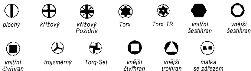
Obr. 4. Přehled nejběžnějších břitů šroubováků
