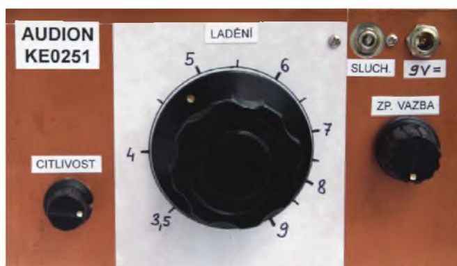
Obr. 12. Příklad uspořádání a popisu ovládacích prvků na předním panelu zpětnovazebního přijímače
