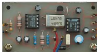
Osazená deska s plošnými spoji přijímače MRX-80
