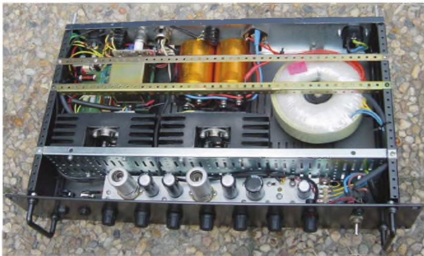
Obr. 93. Rozmístění dílů v nástrojovém zesilovači 200 W
