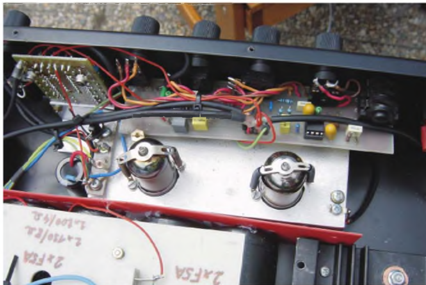
Obr. 75. Předzesilovač s 2x ECC83 a operačním zesilovačem vestavěný do skříň nástrojového zesilovače
