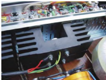
Obr. 84. Upevnění izolovaných chladičů v zesilovači pomocí laminátových destiček
