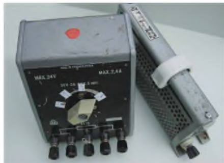
Obr. 4. Zatěžovací rezistory o zatížitelnosti 100 W
