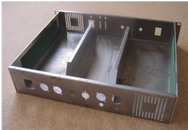
Obr 3b. Sestavená skříň zesilovače
