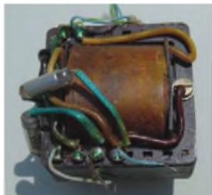
Obr. 48. Linkový transformátor s kompenzačními kondenzátory
