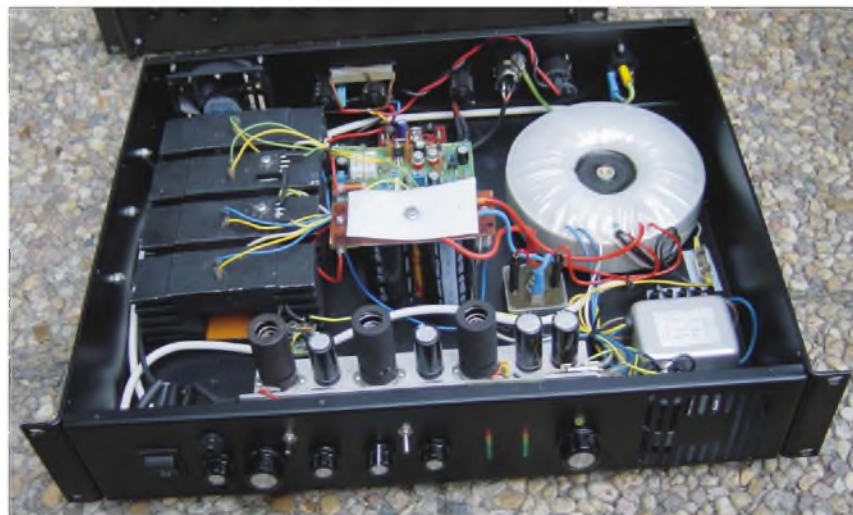
Obr. 72. Předzesilovač s 2x ECC83 a 1x ECC82 vestavěný v nástrojovém zesilovači o výkonu 200 W
