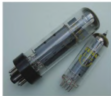
Obr. 9. Koncové pentody EL34 a EL84
