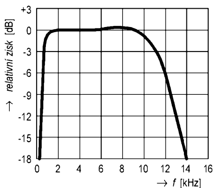
Obr. 25. Typická kmitočtová charakte- ristika zesilovače s elektronkou s kom- penzací poklesu vyšších kmitočtů
