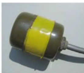
Obr. 47. Stíněný mikrofonní transformátor z profesionálního zařízení
