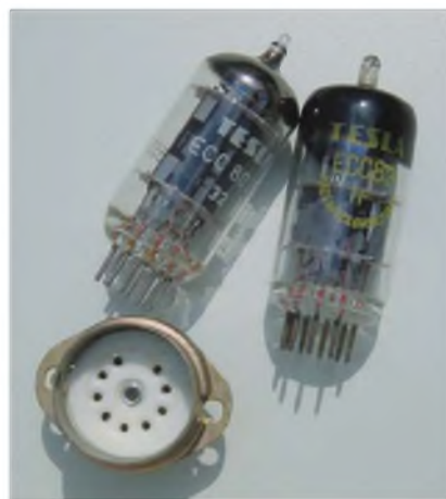
Obr. 8. Dvojitě triody typu ECC83 (803)
