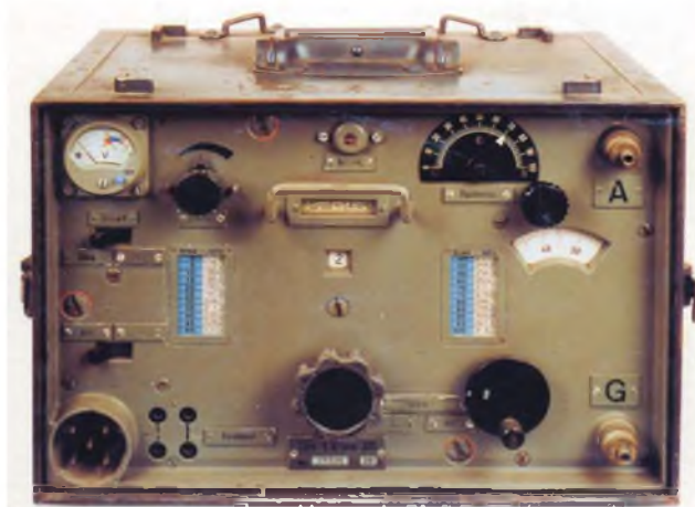
Transceiver první generace typu SEa2/24b-202 s typickým designem (rastrovaným odlitým panelem) firmy Lorenz
