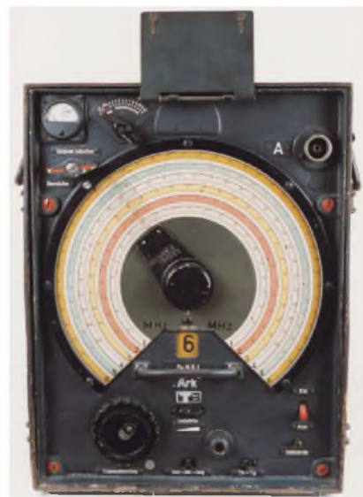
Odposlechový přijímač řady Horst, mezi amatéry přezdívaný „Paví oko“
