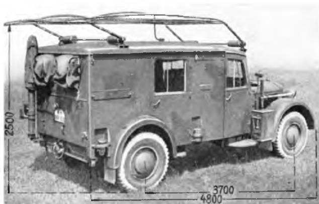
Střední radiovůz Kfz 17 s typickou střešní anténou byl vybaven radiostanicí 15 WSE
