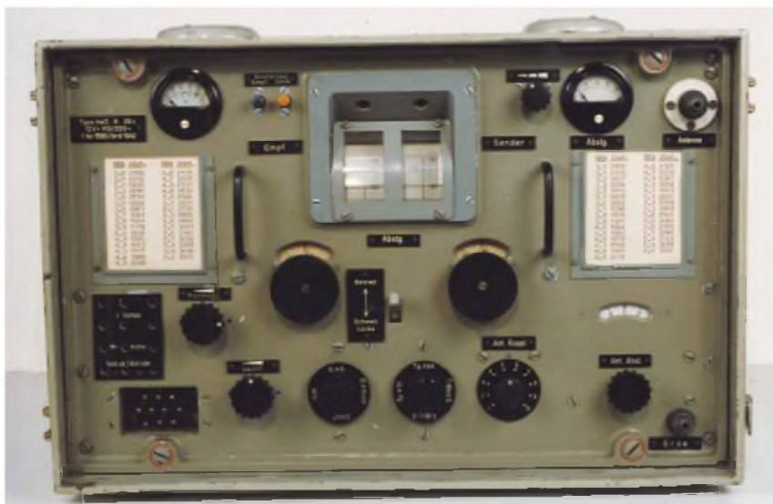
Přijímač-vysílač od firmy Hagenuk byl určen pro menší plavidla. Výkon vysílače byl 15 W. Přístroj pracoval v rozsahu krátkých vln.
