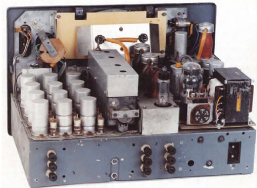
Firma Rohde & Schwarz dávala přednost vzdušnějšímu uspořádání interiéru, jak je patmo na fotografii ponorkového měřičiho přijímače RAS (nahofe). I u Philipsů měli rádi „průvan“ ve skříně přístroje, jak je zřejmé z obrázku komunikačního přijímače Philips CR 101. Oba přístroje jsou zatíženy konstrukční manýrou poloviny třicátých let
