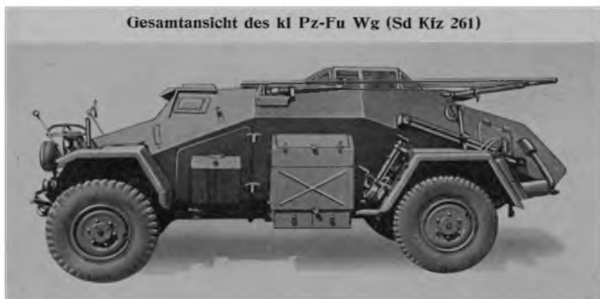
V roce 1942 byl dán do výzbroje armády nový průzkumný vůz (Sd)(Kfz261), který již byl vybaven rádiovou sadou Fu 8 podle nového standardu z roku 1940. Vysokofrekvenční energie byla vyzařována střešní anténou (Dachantenne). Na obrázku je ji vidět ve sklopené poloze
