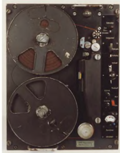
Univerzální goniometrický přijímač EP2. S tímto přijímačem jsme se mohli setkat u všech druhů vojsk. Byl instalován i na ponorkách, jak vidíme na obrázku vpravo nahoře na stránce 28.
