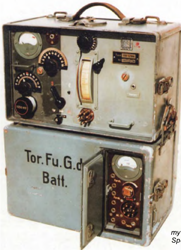
Jeden z prvních přístrojů první generace - VKV přenosný transceiver typu TSE 1/208 z roku 1934. Je ještě osazen nožičkovými elektronkami H406, RE084 a RES164. Přístroj byl zkonstruován firmou Telefunken
