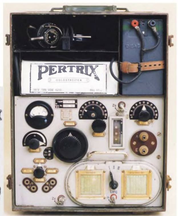
Přístroje z konce první generace spojovací techniky pozemního vojska byly ještě konstruovány s nožičkovými elektronkami. Na fotografiích je rádiová sada Fu 10 s třicetivattovým vysílačem (dole vlevo) a přijímačem E445Bs (dole vpravo), předchůdcem přijímače Torn Eb. Kompletem byly vybaveny průzkumné vozy wehrmachtu. Na přístrojích je patrná konstrukční škola Telefunken. V roce 1936 těmito stanicemi byly vybavovány lehké pancéřované průzkumné vozy (Sd. Kfz. 223)
