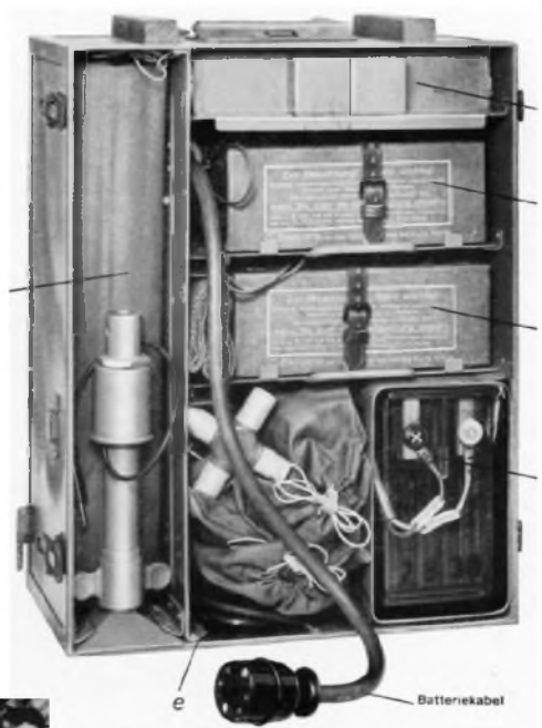
Přenosná radiostanice řady Tom.Fu. se zdrojovou skříní byla používána pro střední stupeň velení
