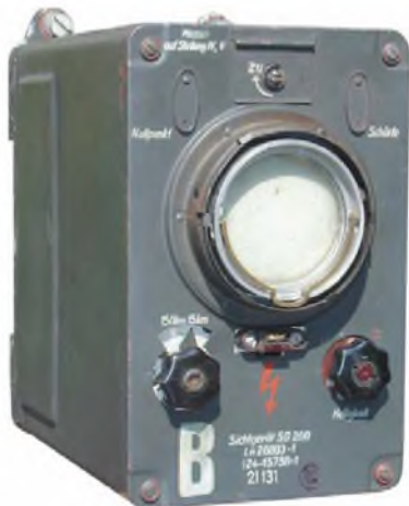
Monitor (varianta B) pro odečítání vzdálenosti a směru sledovaných objektů. Vlevo přepínač pro nastavení rozsahu vzdálenosti, vpravo knoflík pro nastavení jasu.
