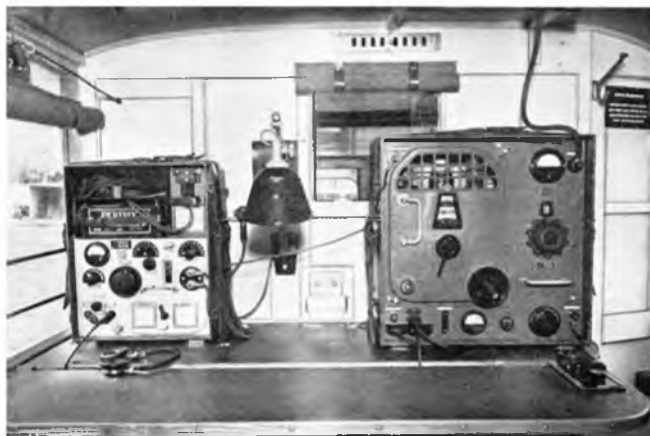
Rádiovou sadu FU 20 tvořil přijímač Torn Eb a vysílač 30 WSa. Byly jí vyzbrojeny obrněné transportéry
