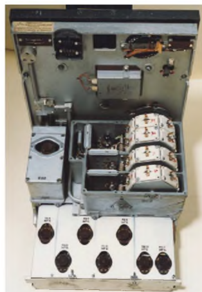
Přijímač Fu H.E.f. (nahore a dole) uzavíral frekvenční spektrum odposlechu na kmitočtu 300 MHz. Vstup byl osazen žaludovými elektronkami a zbytek elektronkami RV2, 4P700.
