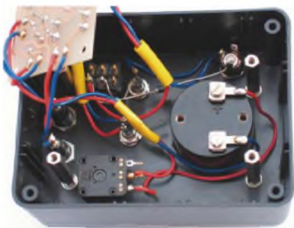
Obr. 7. Rozmístění a zapojení součástek uvnitř krabičky testeru
