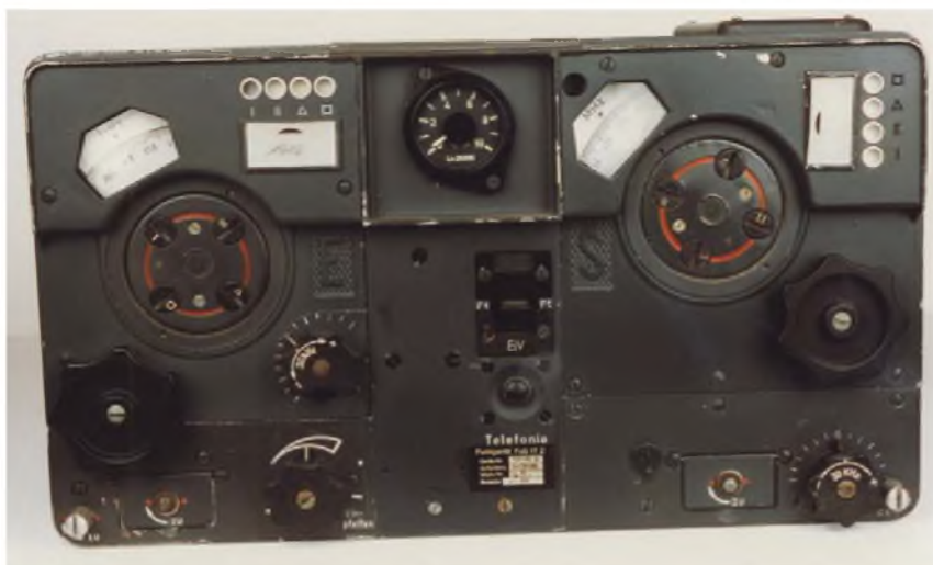
Rádiová stanice FuG 16 pro malá letadla (Me 109, Me 262, Fw 190). Vlevo je přijímač, uprostřed modulátor a vpravo vysílač
