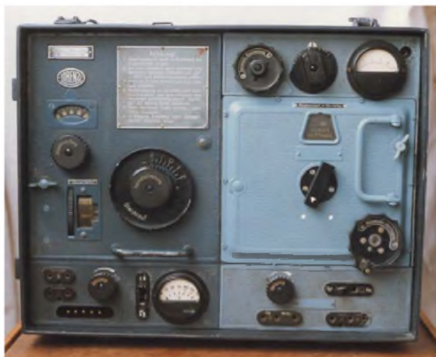
Transceiver první generace typu SEa2/24b-202 s typickým designem (rastrovaným odlitým panelem) firmy Lorenz
