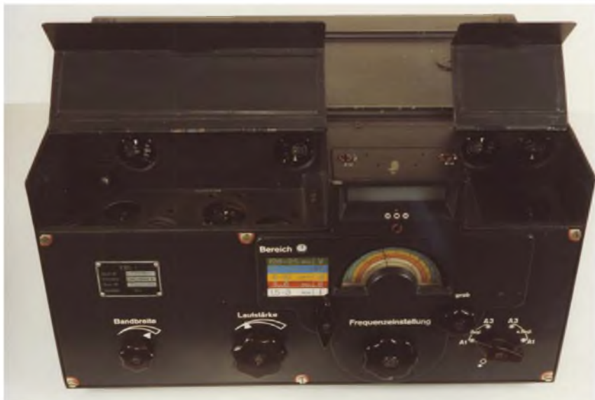
Špičkový přijímač E 52 od firmy Telefunken, který předběhl svou dobu nejméně o dvacet let. Sovětům posloužil jako vzor pro přijímač R 110 M
