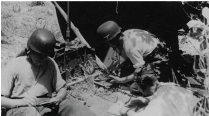
Přenosná radiostanice řady Tom.Fu. se zdrojovou skříní byla používána pro střední stupeň velení
