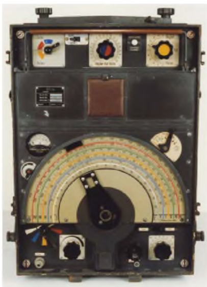
Univerzální goniometrický přijímač EP2. S tímto přijímačem jsme se mohli setkat u všech druhů vojsk. Byl instalován i na ponorkách, jak vidíme na obrázku vpravo nahoře na stránce 28.
