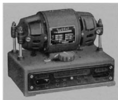
Rotační měnič pro pětivattový vysílač.
