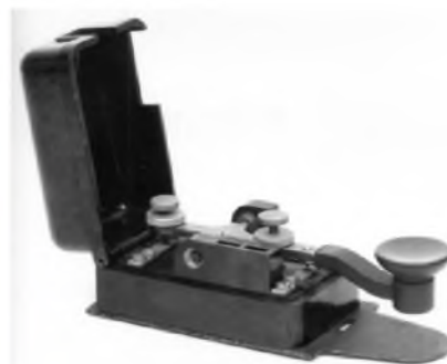
První typ leteckého telegrafního klíče s označením T.2 od firmy Lorenz, určený pro rádiovou sadu FuG X
