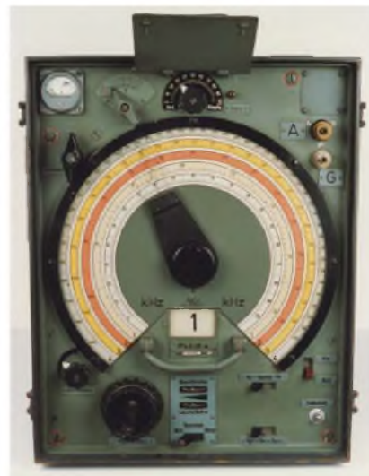
Přijímač Fu H.E.f. (nahore a dole) uzavíral frekvenční spektrum odposlechu na kmitočtu 300 MHz. Vstup byl osazen žaludovými elektronkami a zbytek elektronkami RV2, 4P700.
