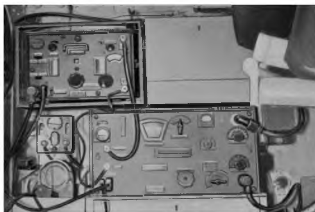
Rádiovou sadu FU 20 tvořil přijímač Torn Eb a vysílač 30 WSa. Byly jí vyzbrojeny obrněné transportéry
