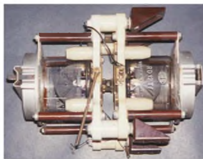
Vysílací díl FuG 200. Vlevo a vpravo jsou vysílací elektronky (triody) RD12Tf, mezi nimi je symetrické vf vedení, na jehož konci je posuvný zkratovací můstek pro nastavení kmitočtu. Na horní straně byla umístěna vazební smyčka k vyvedení vf energie k anténnímu přezpůsobovacímu obvodu
