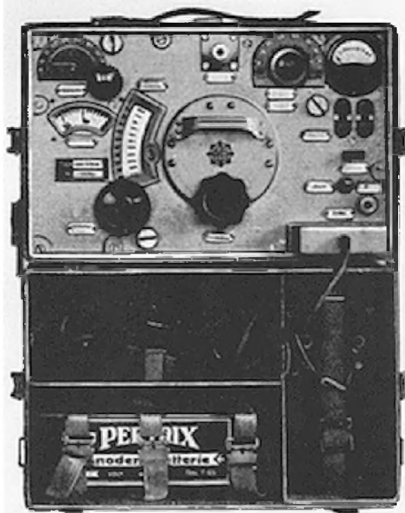
Mezityp vševojskového přijímače s označením b, který byl později nahrazen Tornem Eb. Torn Eb byl univerzální přijímač a mohli jsme s ním setkat jak u pozemního vojska, tak u letectva a námořnictva
