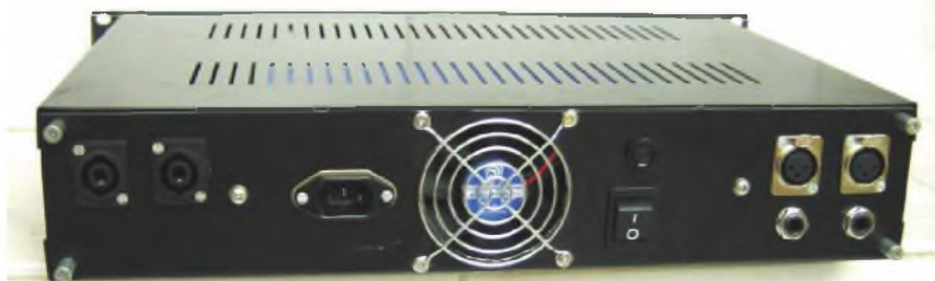
Obr. 100. Zadní stěna PA zesilovače o výkonu 2x 300 W. Vlevo jsou dva výstupy pro reproduktory (zásuvky Speakon), vpravo jsou dva vstupy - symetrické (zásuvky XLR) a nesymetrické (zásuvky JACK). Uprostřed je zleva síťová přístrojová vidlice, ventilátor, síťová pojistka a síťový spínač
