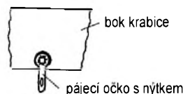
Obr. 34a. Stinice krabičky na vstupní jednotku (materiál - plech FeSn o tloušťce 0,5 mm)
