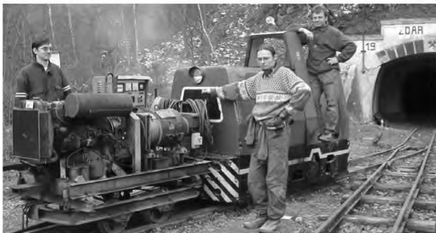
Lokomotivy tu jezdí nejen dieselové, ale i dieselelektrická BNE50 (50 HP) a elektrická s roztomilým názvem „Elektrula“, jak ji známe z filmu Tajemný hrad v Karpatech (na snímku). Elektrula se správně jmenuje Metalist B-346 a vyrobila ji firma BBA Ave (NDR) v r. 1973. Pohón: baterie 80 V/260 Ah, motor 2x 2,6 kW
