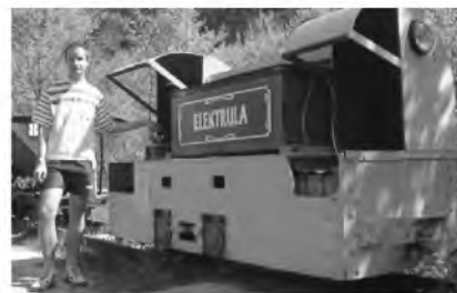
Lokomotivy tu jezdí nejen dieselové, ale i dieselelektrická BNE50 (50 HP) a elektrická s roztomilým názvem „Elektrula“, jak ji známe z filmu Tajemný hrad v Karpatech (na snímku). Elektrula se správně jmenuje Metalist B-346 a vyrobila ji firma BBA Ave (NDR) v r. 1973. Pohón: baterie 80 V/260 Ah, motor 2x 2,6 kW
