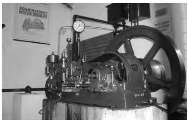
Pohled do strojovny neboli mašinhausu, který byl a už opět je hlavním zdrojem energie v kamenolomu. Vlevo snímek z r. 1930, kdy byl ve strojovně dieselový motor Deutz. Vpravo dnešní rekonstruovaná strojovna s naftovým motorem Gerhard Adam o výkonu 8 HP (z Oskavy-Bedřichova na Severní Moravě), pohánějícím generátor 220/380 V, 10 kW a další stroje
