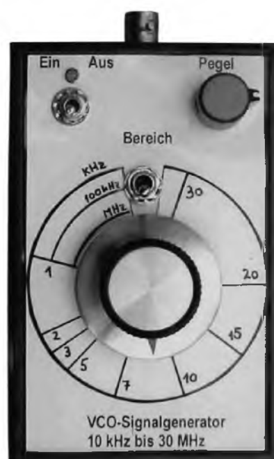
Obr. 17. Pohled shora na vf signální generátor s monolitickým VCO
