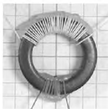
Obr. 42. Praktické provedení transformátoru
