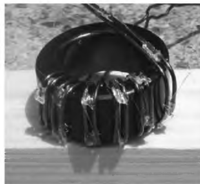
Obr. 24. Balun navinutý dvoulinkou vlastní konstrukce
