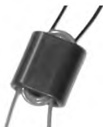
Obr. 20. Praktické provedení balunu na dvouotvorovém jádře
