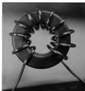
Obr. 43. Praktické provedení cívky na toroidním jádru
