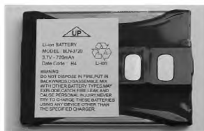
Obr. 12. Akumulátory LI-ION použité ve stanici ELIX SL-01P
