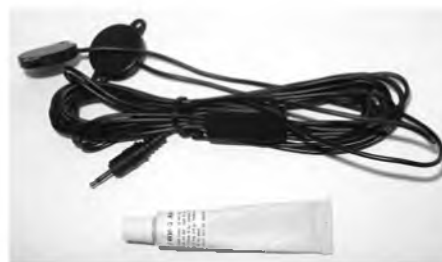
Obr. 10. Piezokeramické nalepovací čidlo pro snímání otřesů
