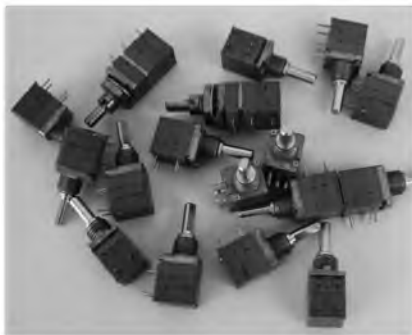
Obr. 5. Kvalitní potenciometry ALPS používané ve stanicích ALINCO
