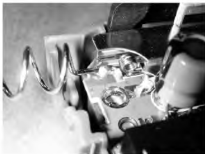
Obr. 2. Pohled na základní desku s původní anténou vysunutou z ochranného krytu
