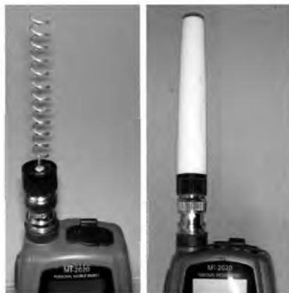
Obr. 19. Výměnná šroubovicová anténa. Vlevo bez krytu, vpravo v krytu z popisovače Centro-fix 1710
