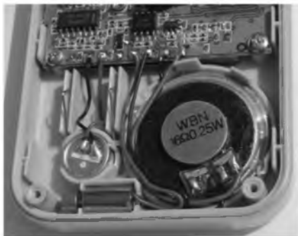
Obr. 9. Detail ústrojí vibračního vyzvánění ve stanici ELIX SL-01P
