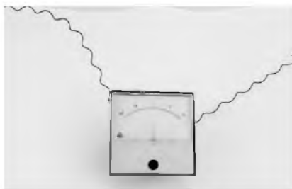
Obr. 45. Jednoduchý měřič síly pole
