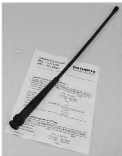
Obr. 42. Flexibilní anténa KATHREIN tvořená lankem
