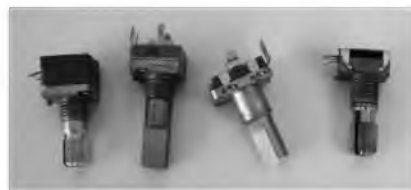
Obr. 6. Rotační enkodéry používané k přepínání kanálů
