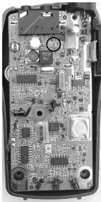
Obr. 31. Vnitřní provedení stanice INTEK MT-4040
