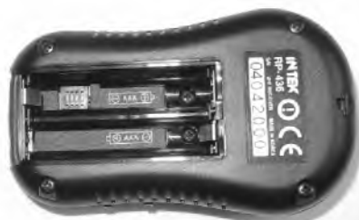
Obr. 11b. Přepínač kanálů na spodní straně přijímače RP-436
