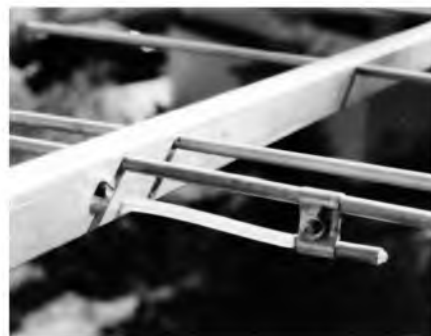
Obr. 13b. Realizovaný bočnickový napájecí obvod zářiče
