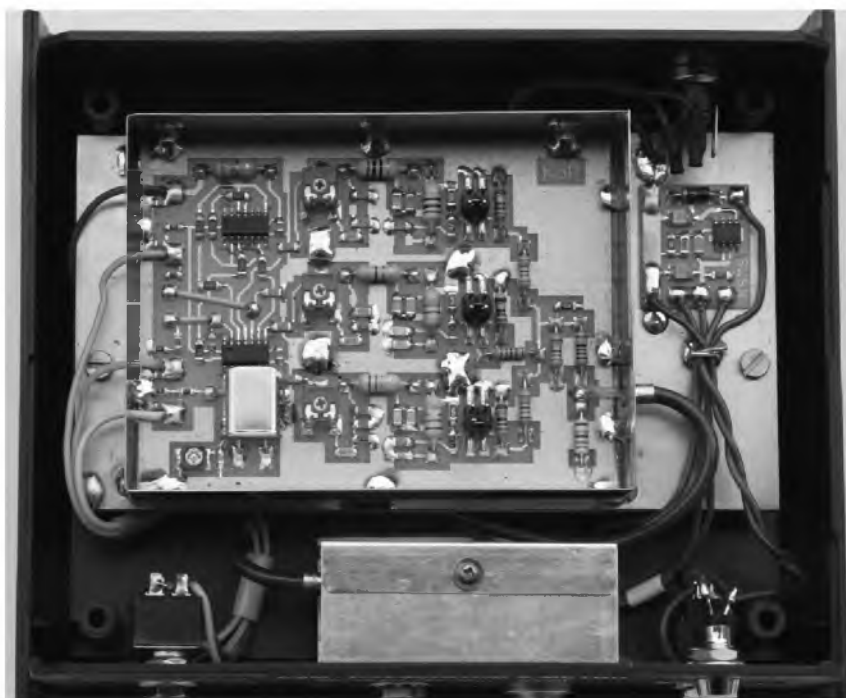
Obr. 7. Uspořádání součástek ve skřínce kalibrátoru
