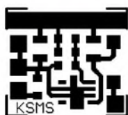
Obr. 5. Obrazec plošných spojů na desce KSMS kalibrátoru (měř.: 1 : 1, deska má rozměry 22,9 x 20,3 mm)
