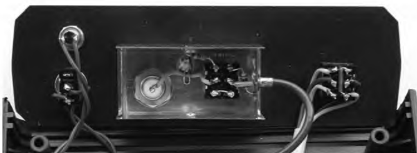
Obr. 8. Součástky na zadní straně předního panelu kalibrátoru
