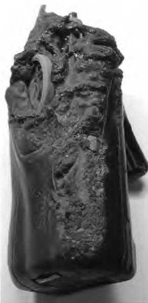
Obr. 25. Plně funkční radiostanice KENWOOD TK-2202 prošlá ohněm
