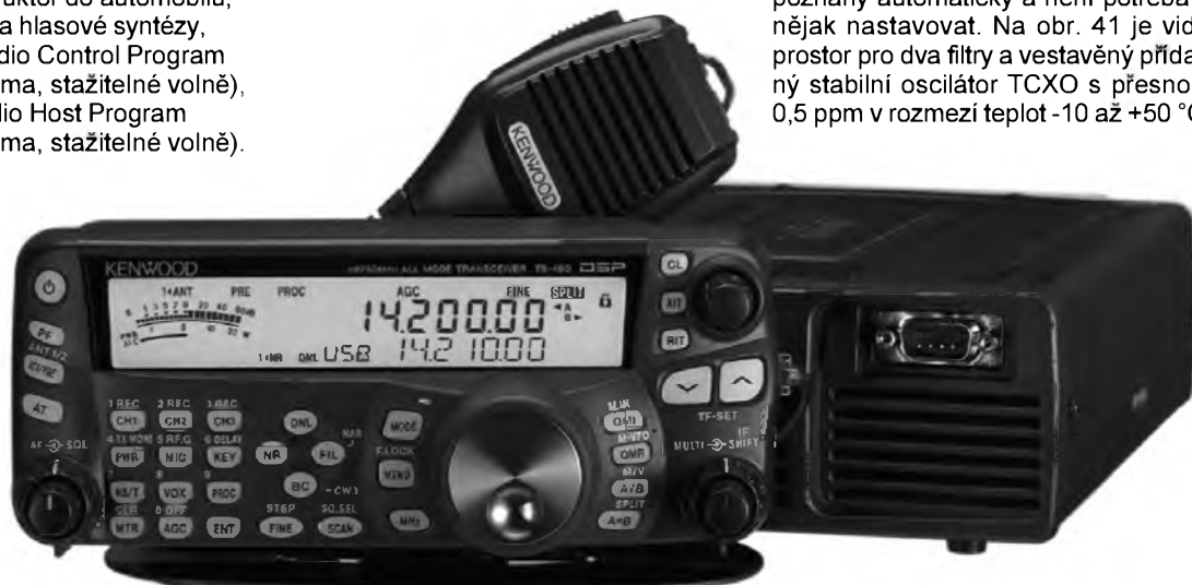
Obr. 34. Špičkový KV transceiver KENWOOD TS-480 SAT. Podobně jako u vozidlových transceiverů tvoří jeho přední panel samostatnou jednotku
