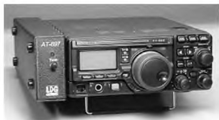
Obr. 71. Antennní tuner LDG AT-897 připevněný k transceiveru
