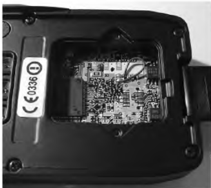
Obr. 11. Modifikační propojka u radio-stanic ALINCO (je to smyčka z drátu vpravo nahoře v otevřeném otvoru)
