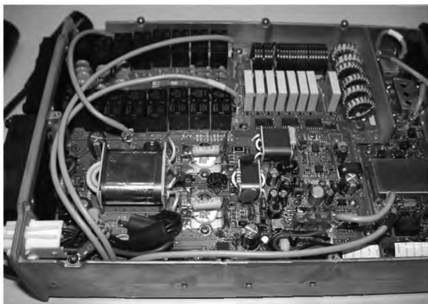
Obr. 44. Koncový stupeň verze transceiveru TS-480 SAT s výkonem 100 W
