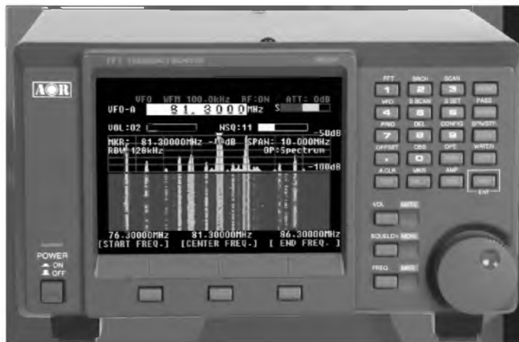
Obr. 61. Přijímač AOR SR-2000 s FFT analyzátozem kmitočtového spektra
