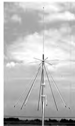
Obr. 88. Širokopásmová diskokružková anténa DIAMOND DISCONE D130J
