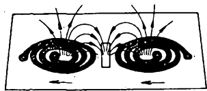
Obr. 61. Vliv feritového jádra umístěného mezi cívkami na jejich vzájemnou vazbu; a) cívky bez jádra, b) s jádrem vloženým do místa A
