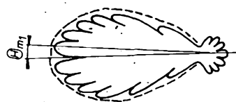
Obr. 37. Vertikální vyzařovací diagram ovlivněný zemí
