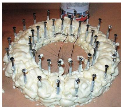
Obr. 7. Cívka zastříknutá pěnou
