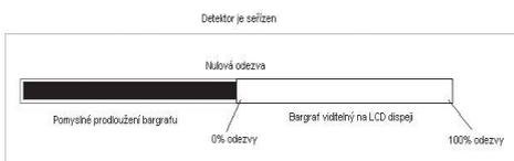
Obr. 3. Princip automatického seřizování
