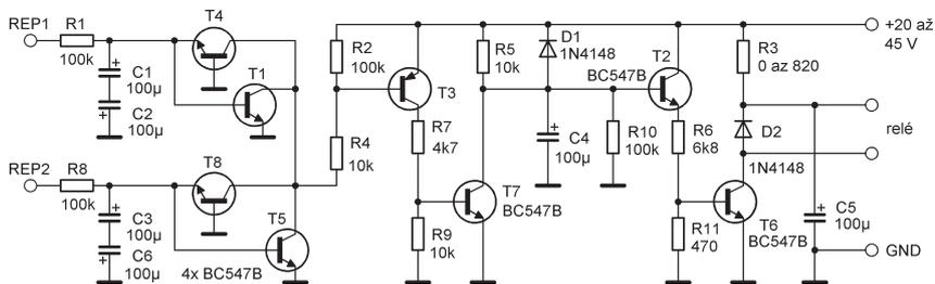
Obr. 1. Schéma zapojenia ochranného obvodu
