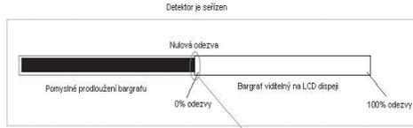
Obr. 4. Princip nastavení citlivosti
