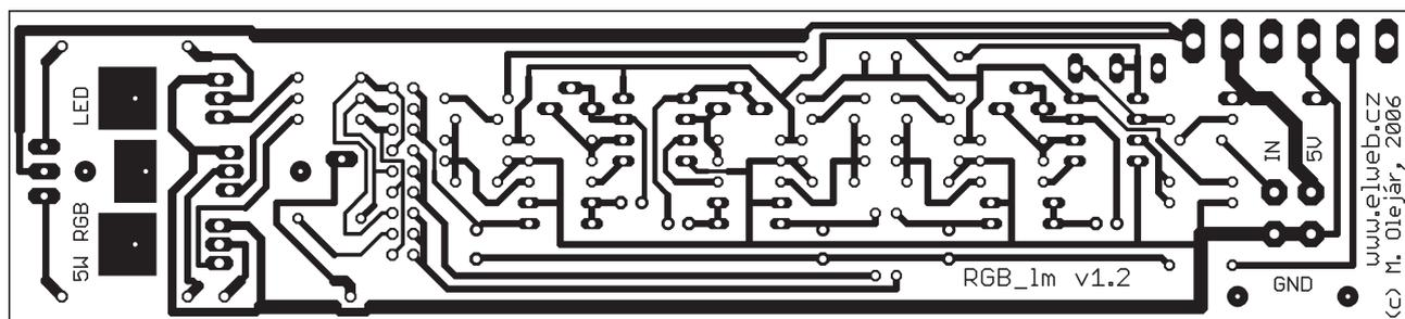
Obr. 3 a 4. Deska s plošnými spoji barevné hudby a rozmístění součástek na desce
