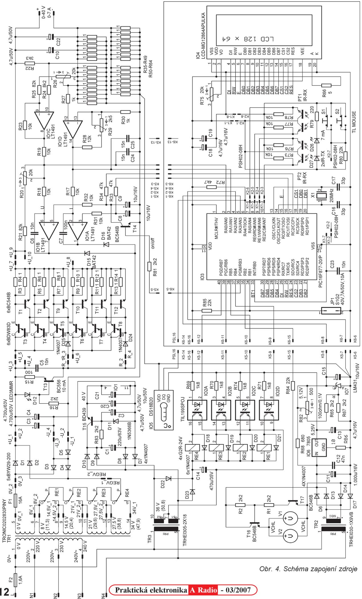
Obr. 4. Schéma zapojení zdroje
