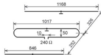
Obr. 41. Tříprvková anténa pro pásmo 144 MHz, rozměry v mm
