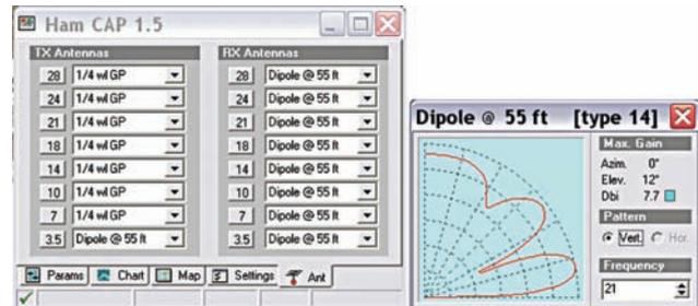
Obr. 4. Nastavení antén u programu HamCAP s možností zobrazení jejich vyzařovacího diagramu ve vertikální rovině (vpravo nahoře)
