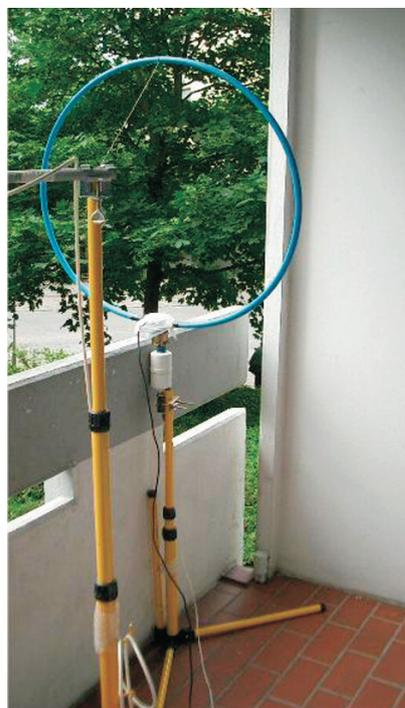
Obr. 26. Rámová anténa na balkóně
