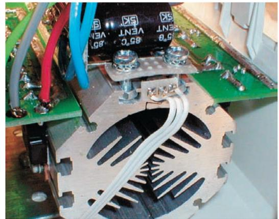
Obr. 5, 6. Krabička s výkonovými součástkami a chladiči
