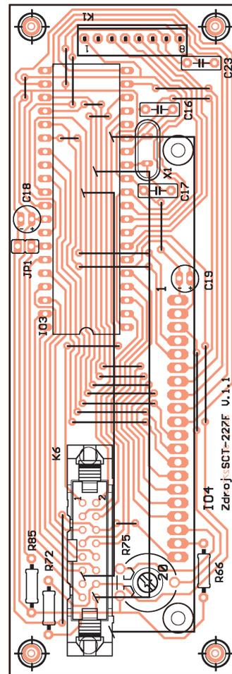
Obr. 8. Rozmístění součástek
