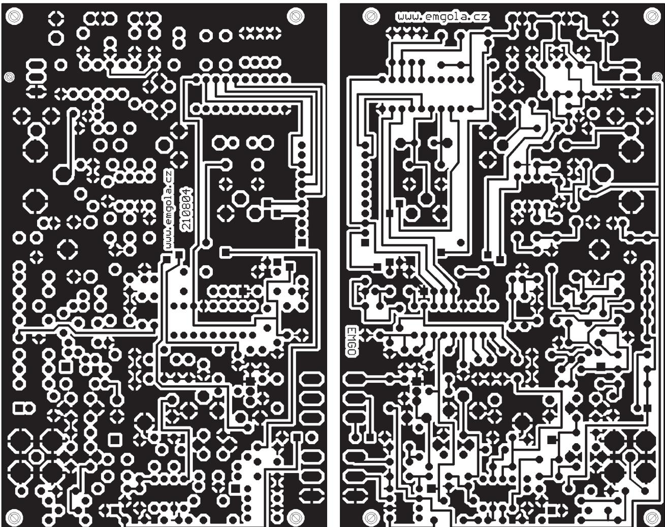
Obr. 17. Deska s plošnými spoji přijímače DRM
