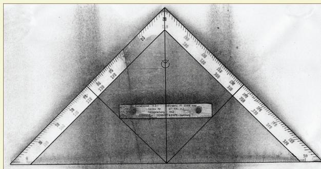
Obr. 13. Letecký trojúhelník z roku 1942, typ KD1 - běžný doplněk palubního navigátora. Trojúhelník je z tvrdého organického skla s dřevěným držadlem, umožňujícím práci v rukavicích.
