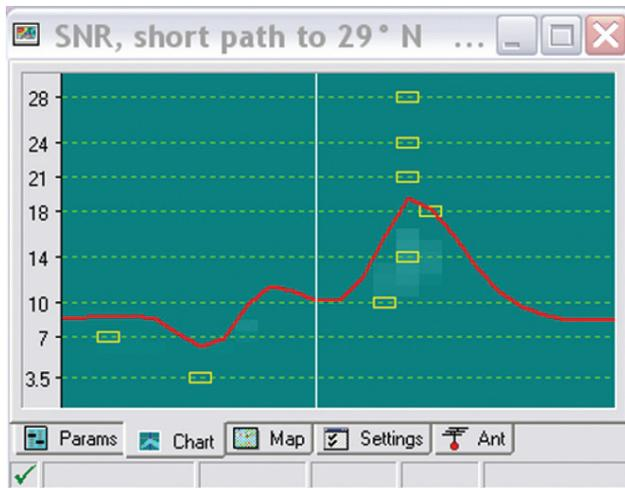
Obr. 3. Graf s časovou osou a pásmy prozradí, je-li příliš pozdě nebo se naopak vyplatí ještě půl hodiny počkat, příp. na jakém pásmu je větší pravděpodobnost navázání spojení. Žluté obdélníčky naznačují optimální čas pro spojení s danou lokalitou na jednotlivých pásmech
