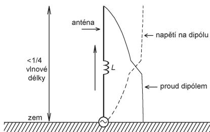
Obr. 35. Zkrácený čtvrtvlnný dipól s prodlužovací cívkou
