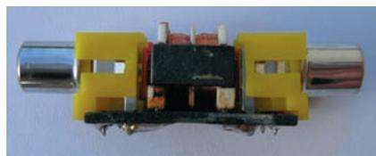
Obr. 4. Pohľad na dosku s oddeľovacími transformátormi z boku
