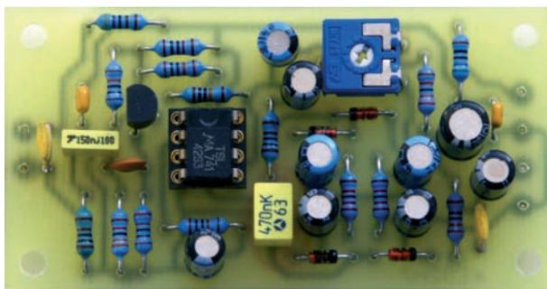
staven dolní mezní kmitočet předzesilovače asi 150 Hz. Blokovací kondenzátor C4 dále potlačuje vř složku v signálu z mikrofonu. Ss složka napětí na kolektoru T1 má být 4 až 6 V, aby následující stejnosměrně navázaný operační zesilovač (OZ) IO1 pracoval v lineární oblasti. Požadovanou velikost ss napětí na kolektoru T1 dosáhneme případnou změnou odporu rezistoru R4. Zvětšením odporu R4 se zmenší kolektorové napětí a naopak.
