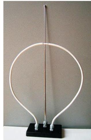
vazba v obou stupních zesilovače určuje nastavení pracovního bodu a velikost zkreslení signálu. Smyčková anténa vykazuje shodné vlastnosti s dlouhohrátkovou anténou délky 10 metrů. Ostře směrová smyčková anténa má nepřehlédnutelnou výhodu oproti dlou-
