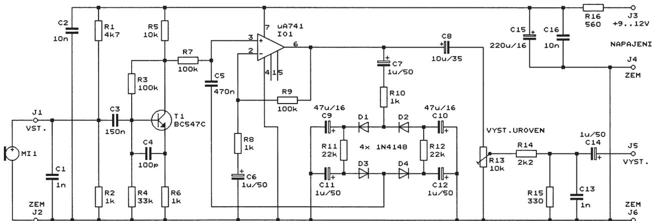
Obr. 7. Kompresor dynamiky signálu z mikrofonu
