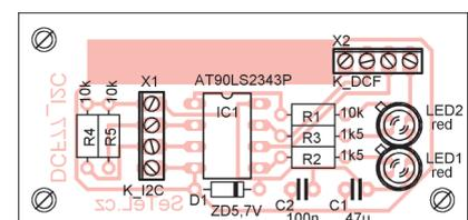
Obr. 2 a 3. Deska s plošnými spoji a osazení modulu
