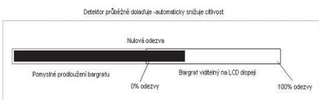
Detektor průběžně doladuje - automaticky snižuje citlivost
