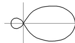
Obr. 42. Vyzářovací charakteristika 3prvkové antény yagi
