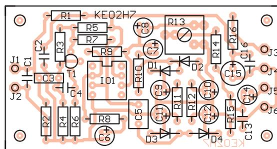
Obr. 9. Rozmístění součástek na desce kompresoru dynamiky
