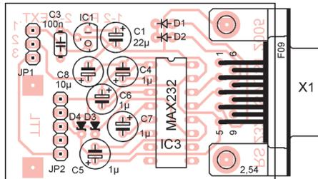
Obr. 5 a 6. Deska s plošnými spoji převodníku RS232 a osazení desky
