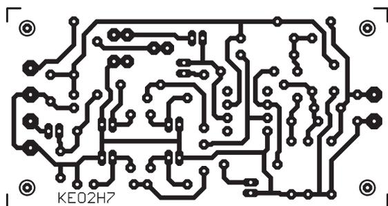
Obr. 8. Obrazec plošných spojů kompresoru dynamiky (měř.: 1 : 1, rozměry 72,4 x 38,1 mm)
