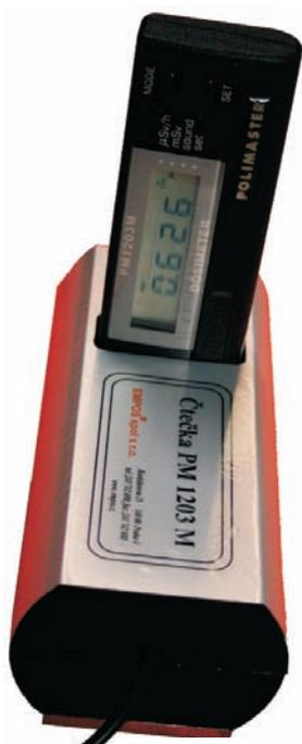
Obr. 2. Dozimetr PM 1203M s interfejsem
