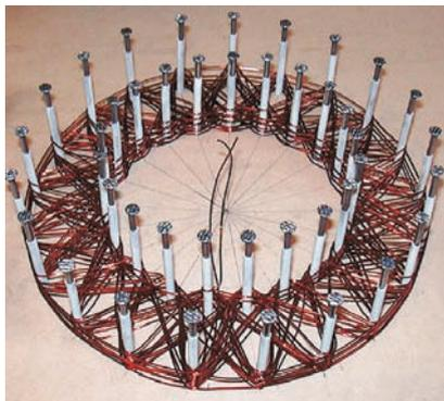
Obr. 6. Cívka připravená k zastříknutí montážní pěnou
