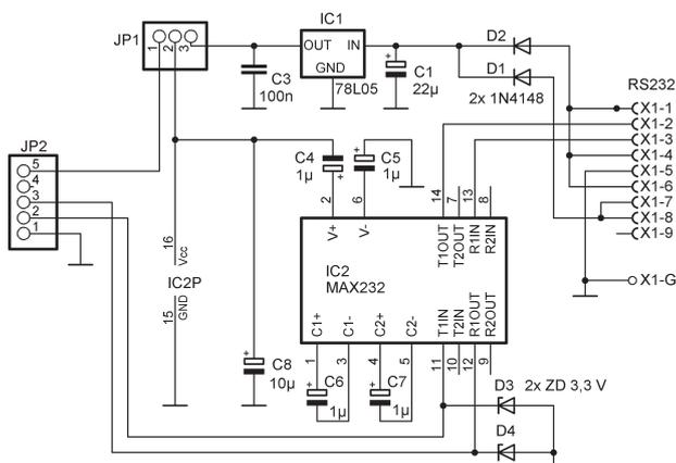
Obr. 2. Zapojení převodníku RS232
