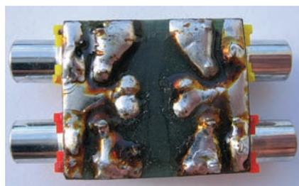
Obr. 5. Pohľad na dosku s oddeľovacími transformátormi zdola
