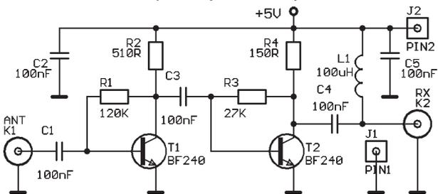
Obr. 23. Schéma zapojení předzesilovače
