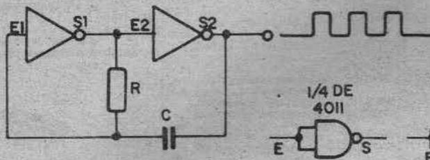
Onde F é a frequência em Hz, "1,4" é uma constante ("arredondamento" de  $\sqrt{2}$ ), R é o valor do resistor (em megohms) e C o valor do capacitor (em microfarads).
