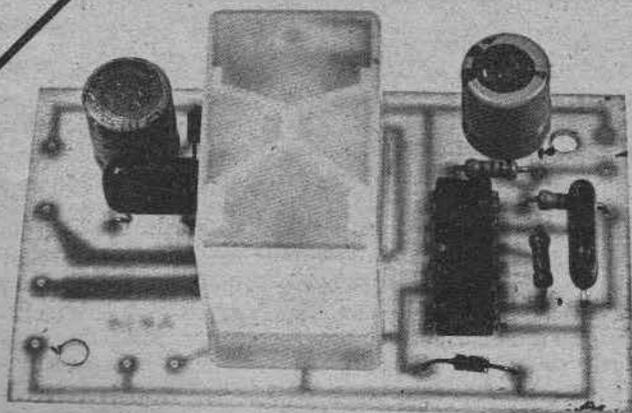
**O DISPARO (TEMPORIZADO E INTERMITENTE) DESSE SENSÍVEL ALARME PARA VEÍCULO (SERVE PARA CARRO OU MOTO, DEPENDENDO DA SUBSTITUIÇÃO DE UM ÚNICO RELÊ) SE DÁ A PARTIR DE QUALQUER PEQUENO MOVIMENTO OU "BALANÇO" IMPRIMIDO AO CARRO OU MOTO! A PROTEÇÃO É TOTAL, A INSTALAÇÃO É FÁCILMA E O CUSTO É BASTANTE REDUZIDO.**
