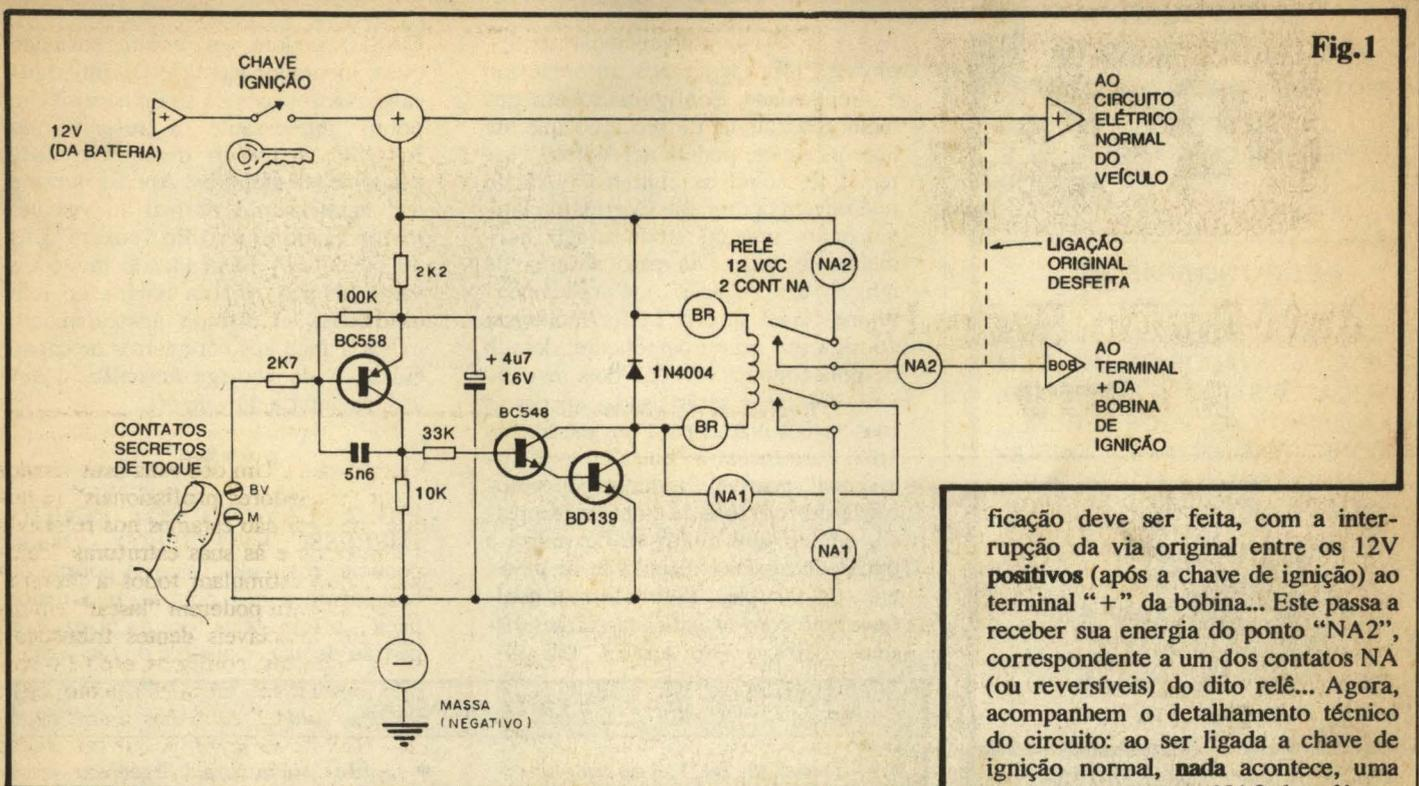
deve controlar toda a Corrente "puxada" pelo sistema elétrico (ou, pelo menos, da ignição e afins...), e assim será inevitavelmente grande, "trambolhudo", difícil de enfiar em algum cantinho não visível do habitáculo (cabine).
