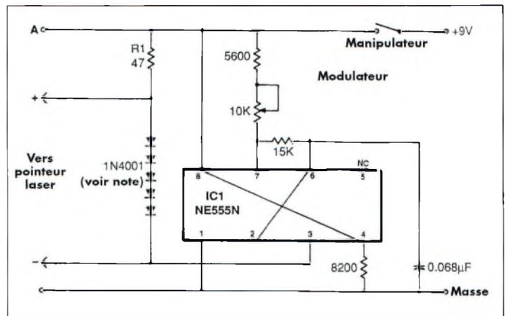
Fig. 2 - Schéma du modulateur.
