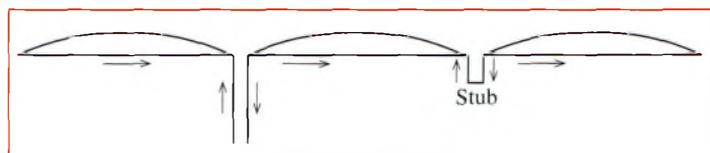
Fig. 6- Antenne colinéaire à trois éléments.
