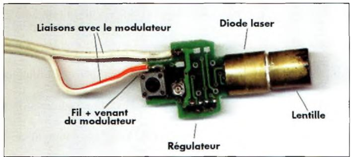
Fig. 3- Le pointeur et la connexion du modulateur.
