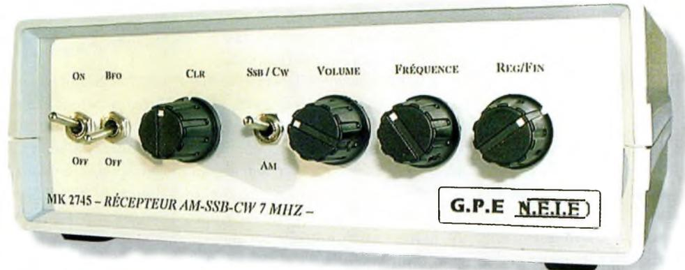
Le récepteur 7 MHz à BFO en France par Nouvelle Électronique Import/Export, est un traditionnel récepteur superhétérodyne. Sa sensibilité est supérieure à 0,4  $\mu\text{V}$  à 12 dB SINAD, tandis que sa sélectivité est de l'ordre de 3 dB SINAD à  $\pm 5$  kHz avec un signal d'entrée de 0,7  $\mu\text{V}$ . Voilà qui présage de longues périodes à l'écoute des radioamateurs, et dans de bonnes conditions.
