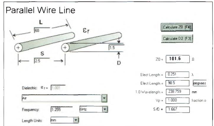
Fig. 6- Deux fils parallèles servent d'adaptateur d'impédance.
