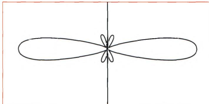
Fig. 8- Diagramme de rayonnement de l'antenne colinéaire.
