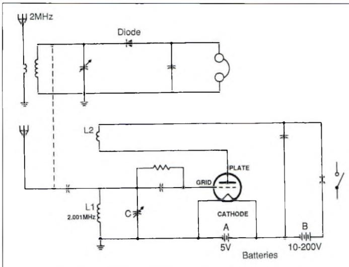
Fig. 3- (Haut) Détecteur à quartz. Une diode fonctionnerait aussi bien (Bas) Oscillateur DeForest. Toute perturbation sur la grille est amplifiée par la triode et renvoie l'énergie RF de L2 vers L1, maintenant L1C à sa fréquence de résonance.
