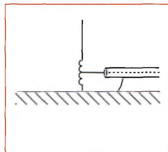
Fig. 4- Schéma de principe de l'antenne 5/8èmes d'onde.
