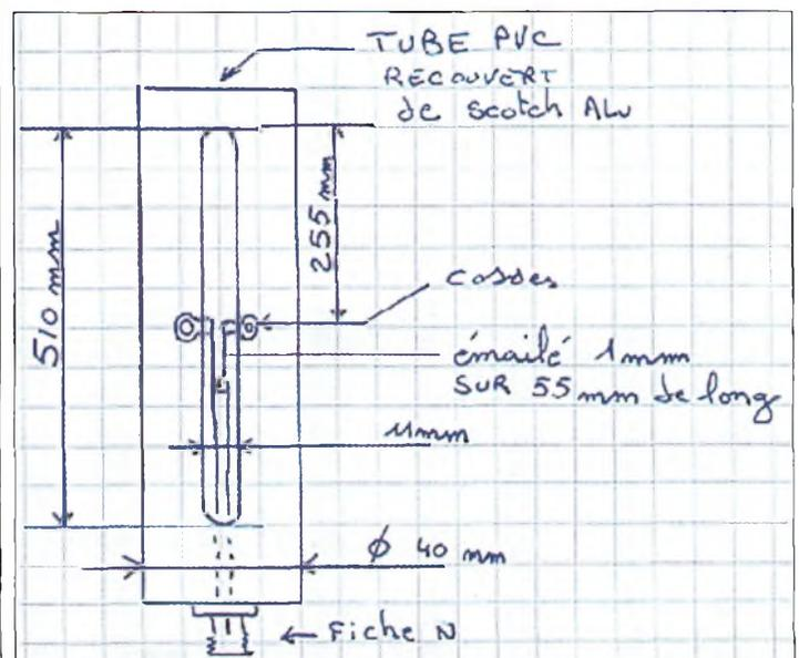
Fig. 11 - Le schéma de l'antenne à fente réalisé par FBBC.
