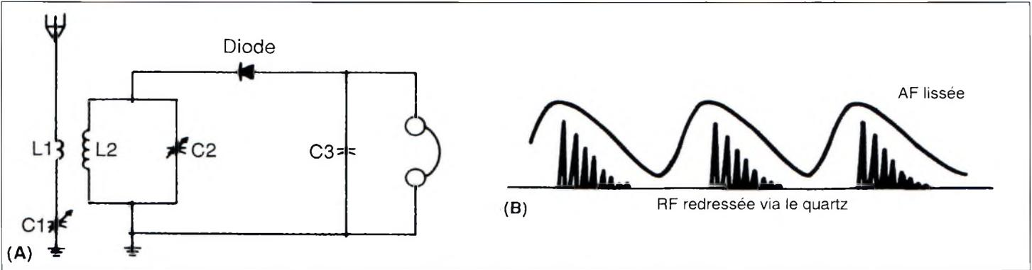
Fig. 2- (A) Circuit simple d'un récepteur à quartz. Dans un détecteur à quartz, le fil au contact de la matière cristalline forme une diode. (B) Courant circulant à travers le quartz et les écouteurs.
