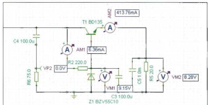
Fig. 3- Le régulateur a été remplacé par un deuxième transistor BD135
