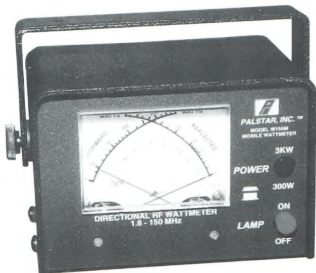
*Le ROS-mètre/wattmètre, qui permet de mesurer les puissances incidente et réfléchie d'une installation d'émission, ne sert pas seulement à indiquer à l'opérateur que son antenne est correctement adaptée. En effet, une installation dont l'antenne rayonne toute la puissance qui lui est appliquée risque moins de brouiller que celle dont l'antenne est désadaptée.*
