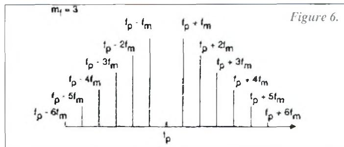
On peut rapprocher de la modulation de fréquence son équivalent qui est la modulation de phase. En fait, quand on modifie la phase d'un signal, on modifie sa fréquence et vice-versa. C'est pourquoi on ne différencie généralement pas ces deux modes de modulation qui, en pratique, conduisent à des résultats très similaires. Il est à noter qu'en modulation d'amplitude, pour lut-
