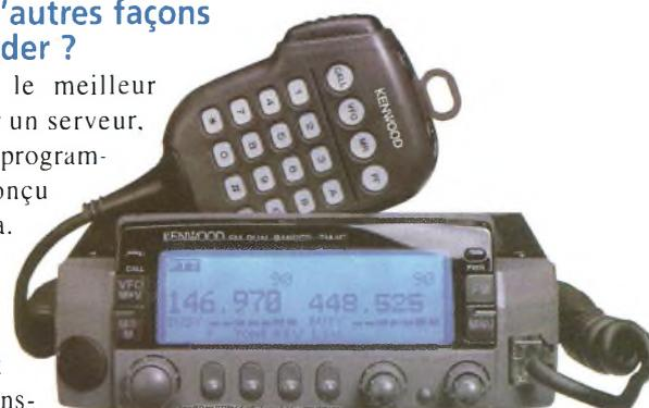
Un réseau 9 600 Bauds étant préférable, le transceiver doit être adapté à ce type de trafic. Ici, le Kenwood TM-V7E.
