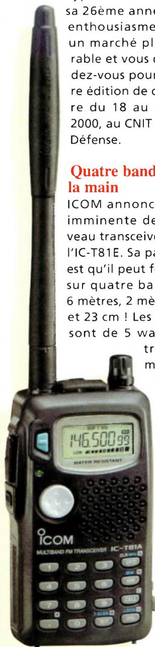
ICOM présente un appareil compact doté de quatre bandes, l'IC-T81E.
