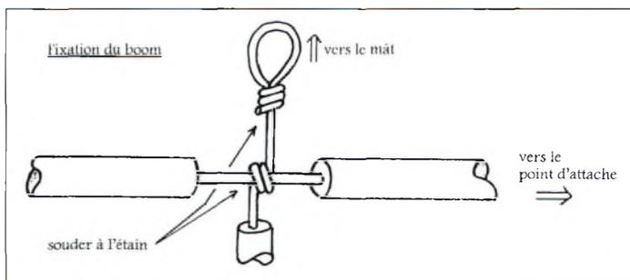
Fig. 3— La fixation des éléments sur le «boom».
