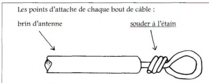
Fig. 2— Détail des points d'attache au bout des fils.
