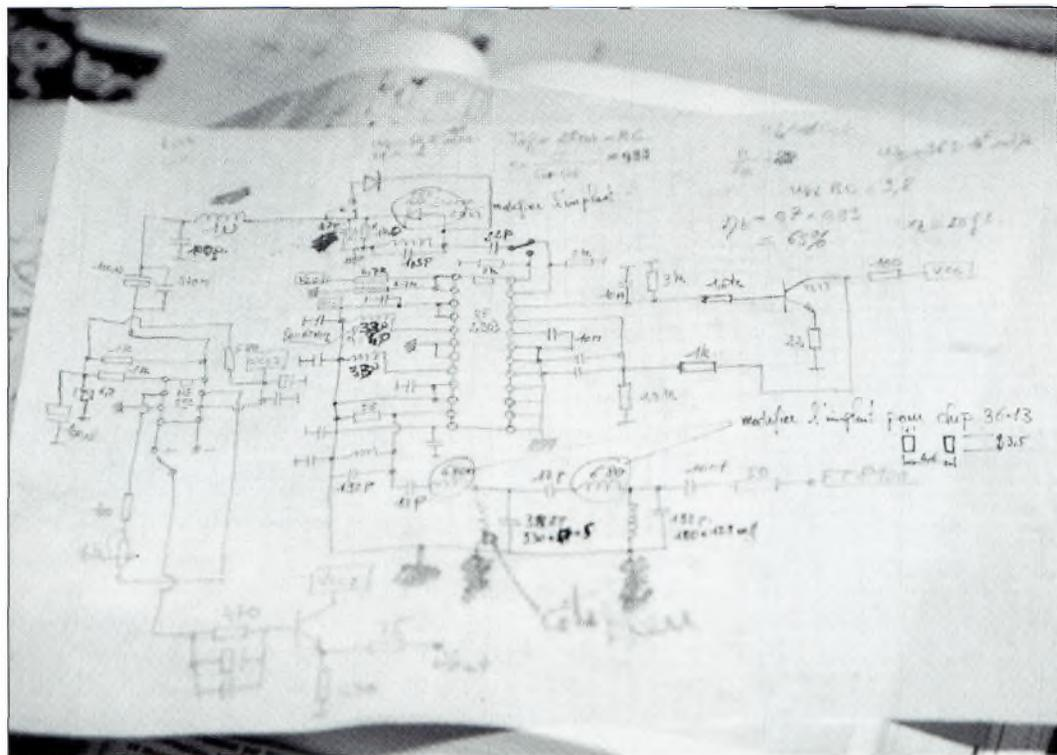
Le schéma du démodulateur vidéo sur 58 MHz, un circuit RF2903 en est le cœur.
