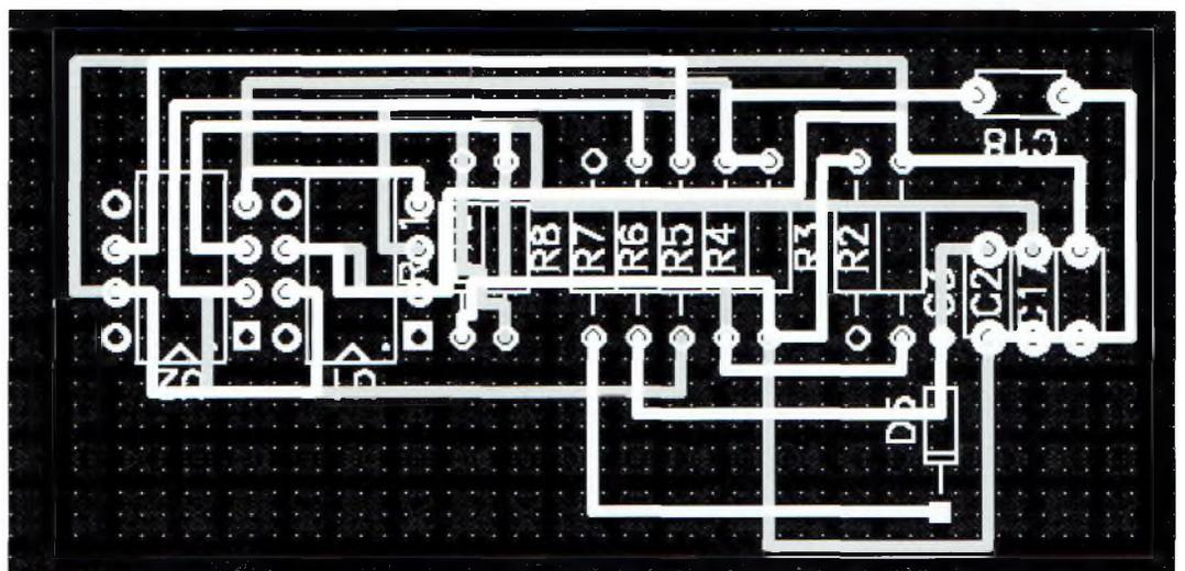
Fig. 4— Tracé du circuit imprimé (toutes les couches).
