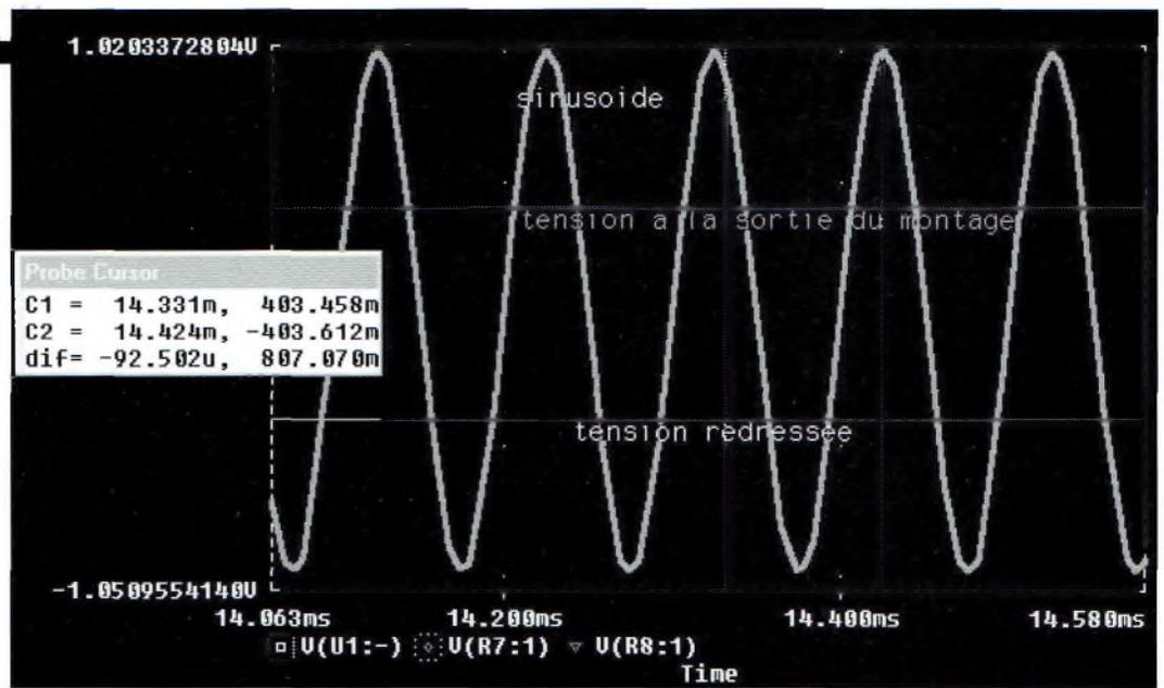
Fig. 2— Résultat. La sinusoïde représente le signal à détecter tandis que la ligne droite du bas trace la tension moyenne redressée. La réplique de cette tension est signalée par le tracé du haut. Elle correspond à «l'image» de celle qui est appliquée sur la résistance R7. Comme on peut le constater, il n'y a que quelques millivolts d'écart entre les deux.
