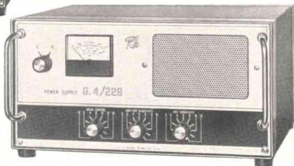
Il trasmettitore G. 4/228 è appositamente studiato per la trasmissione a banda laterale unica SSB; esso inoltre consente la trasmissione in CW, DSB e AM. Unitamente alle ottime doti di potenza e di stabilità sono da sottolineare alcune nuove caratteristiche: la soppressione della portante è effettuata a mezzo di una valvola 7360; la soppressione della banda laterale indesiderata è ottenuta mediante filtro a quarzo. E' possibile il funzionamento automatico sia in grafia quanto in fonia.
