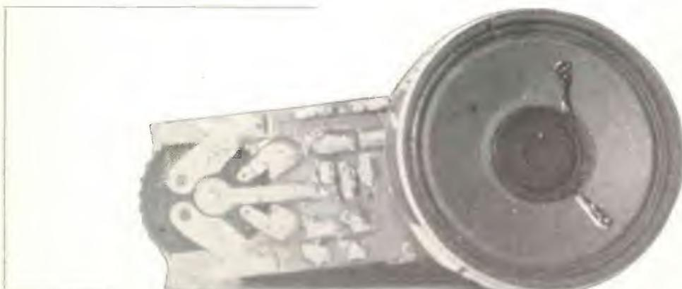
Fate come volete comunque, usando per l'alimentazione delle celle al mercurio (3 per un totale di 4,2 volt), e usando l'interruttore del potenziometro per l'alimentazione generale, se farete la versione amplificata, un interruttore giapponese a slitta se invece farete la versione « con auricolare ».
