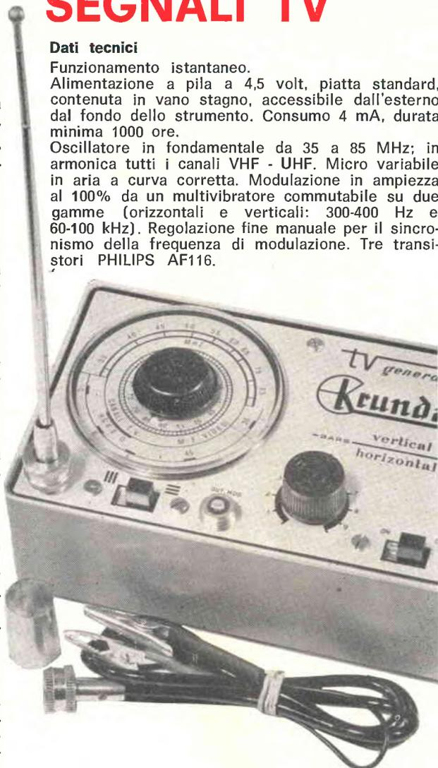
Uscita con innesto coassiale a vite per l'antenna a stilo e il cavetto a cilindro; idem separata dal segnale di modulazione per usi esterni (onda quadra). Quadrante tracciato a mano singolarmente per ogni strumento.
