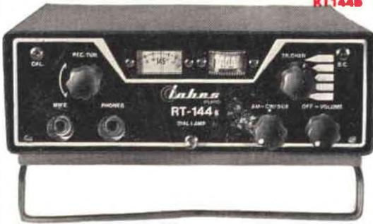
Ricetrasmittitore portatile per 12 mt. Completamente transistorizzato.
