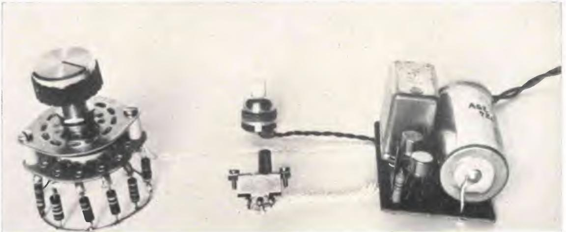
Una volta costruito l'apparecchio si controlli che la tensione tra il collettore di  $Q_2$  e massa non sia inferiore a 0,5 V. Infatti, in caso contrario, e nella malaugurata ipotesi di un condensatore ad elevate perdite, può succedere che l'apparecchio non si disecciti, soprattutto per valori elevati di  $R$ . Se detta tensione dovesse essere inferiore a 0,5 V si dovrà aumentarla aumentando per tentativi il valore di  $R_3$ .
