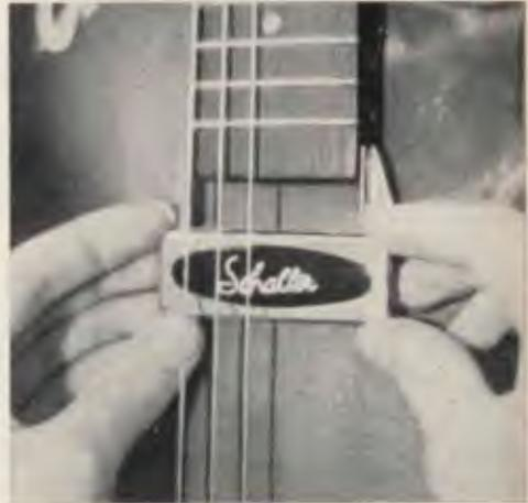
Esempio di montaggio del pick-up sulla chitarra.
