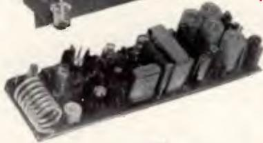
Trasmittitore a transistori per la gamma dei 10 metri
