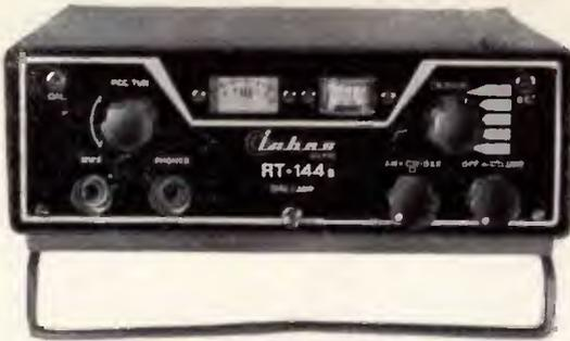
Ricetrasmittitore portatile per i 2 mt. Completamente transistorizzato.
