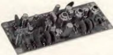
Ricevitore a transistori per la gamma dei 10 metri
