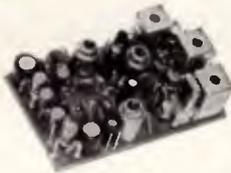
Ricevitore e transistori, di dimensioni ridotte con stadi di amplificazione BF
