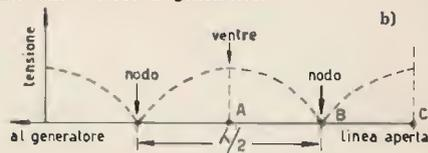
Andamento del valore assoluto della tensione effettiva (somma di quella diretta e di quella riflessa) per ogni punto della linea. Si faccia attenzione al fatto che mentre l'onda, in qualunque senso viaggi, è periodica di una lunghezza d'onda, la configurazione stazionaria che si è formata è periodica di mezza lunghezza d'onda.
