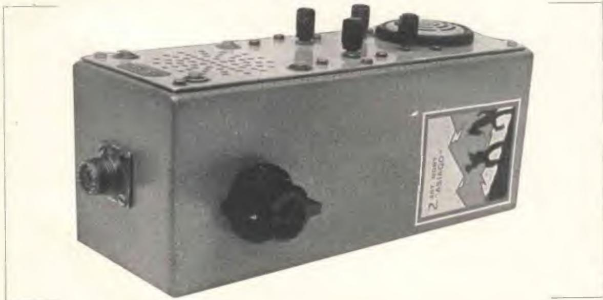
*Il pannello frontale è in alluminio crudo da 1 mm di spessore e viene avvitato alla scatola per mezzo di sei viti da 3 MA i cui dadi sono stati saldati all'interno del bordo del contenitore.*
