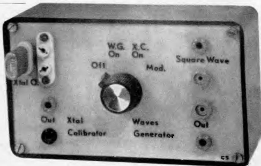
Il modulatore è un oscillatore quasi normale con frequenza di oscillazione di circa 1000 Hz (non ho calcolato la frequenza esatta ma la cosa è di poca importanza) che può essere inserito e disinserito a secondo di quale uso se ne vuole fare.
