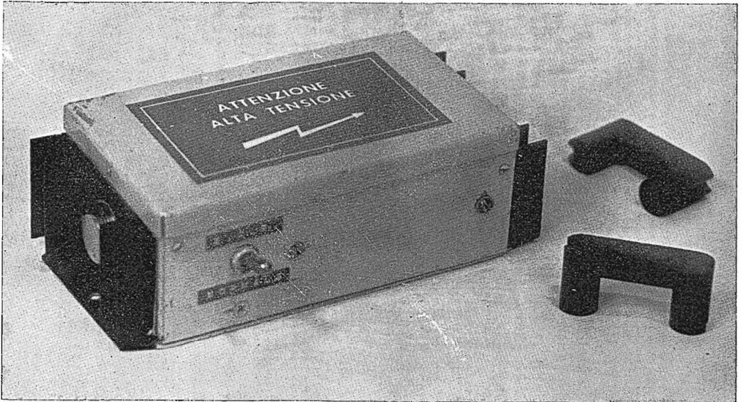
La tensione di batteria elevata a 400 V, raddrizzata da un ponte di diodi (1 A, 800 V), giunge all'anodo del diodo controllato. L'apertura e la chiusura delle puntine fa sì che al « gate » del SCR giunga un impulso positivo che manda in conduzione il diodo controllato e scarica il condensatore posto in parallelo ad esso.
