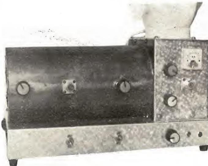
Tutto il complesso è montato sopra un telaio 400 x 270 x 50 mm con ulteriore bordo di 15 mm di alluminio di 1,5 mm (meglio se 2) irrobustito da tre spezzoni di profilato a U di metallo lunghi 265 mm.
