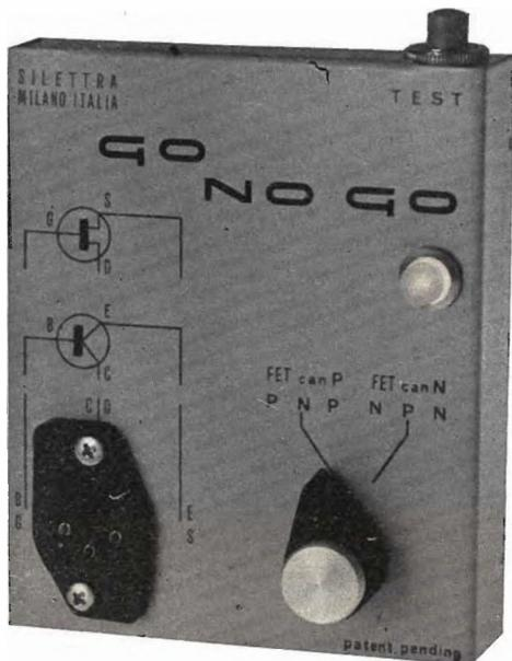
Il « Go-No-Go » è uno strumento di impiego generale e semplicissimo. Se il componente sotto prova è buono, premendo il pulsante « TEST » si accende la lampadina spia; se il componente sotto prova è guasto, premendo il pulsante « TEST » la lampadina spia resta spenta.
