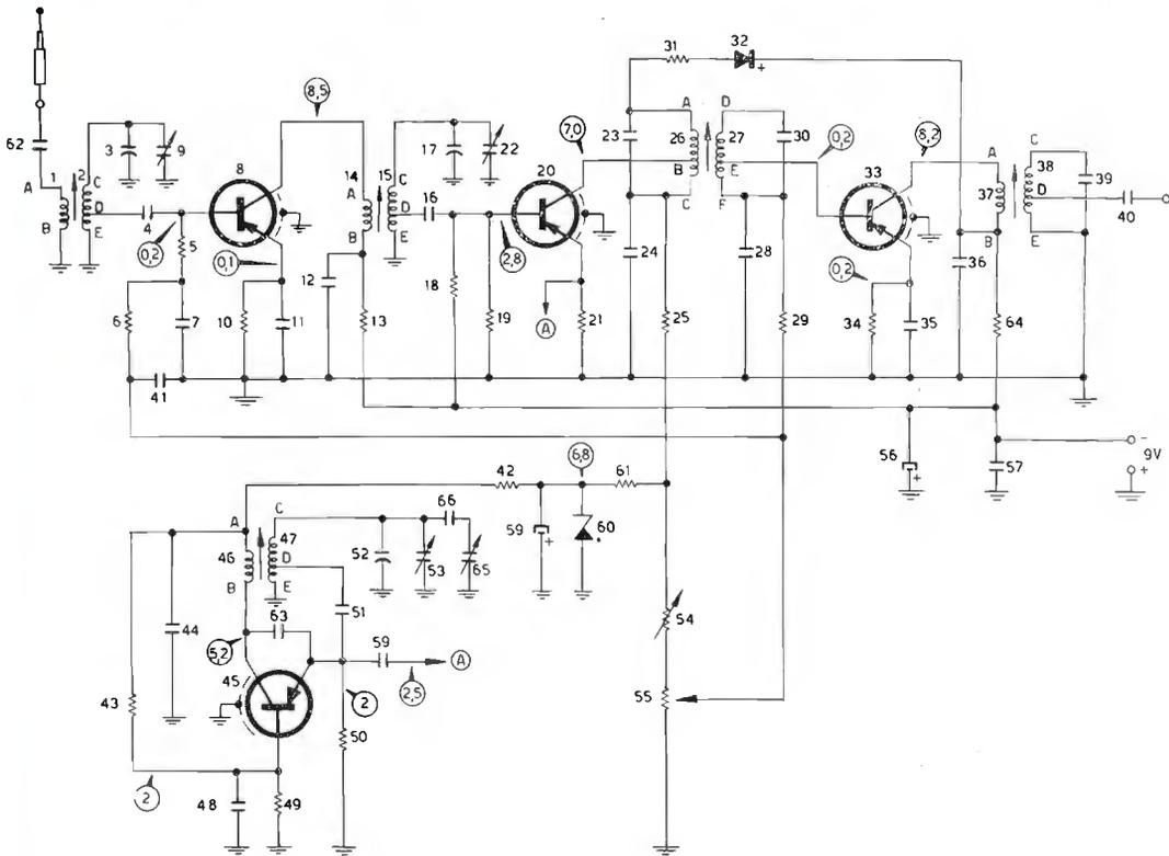
Tensioni misurate con tester ICE 680 C fra punto indicato e massa, in assenza di segnale e controllo sensibilità al minimo. Batterie (2 x 4,5 nuove).
