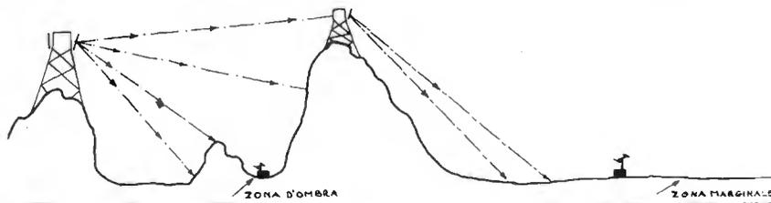
In genere, l'ampiezza dell'area di servizio di una stazione (cioè la zona entro cui il segnale di quella stazione ha intensità tale da permettere una ricezione ottima e stabile) dipende dalla frequenza di trasmissione della stazione, dalla potenza, dall'orientamento delle antenne emittenti, dalla orografia della zona e dal livello dei disturbi entro la zona stessa. Per dare un'idea dell'ordine di grandezza, basta dire che normalmente un'area con raggio massimo di 150 km
