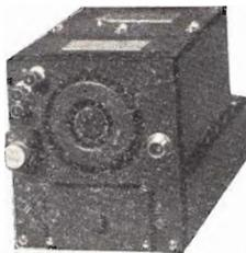
**BC-453** - Versione mod. R-23-ARC5 - Antenna sing. e bilancia-ta - Freq. 190-550 Kc. Medie 85 Kc. con movimento a sintonia variabile. Adatto per essere usato in doppia conversione. Impiega n. 6 valvole metalliche e n. 2 12SK7 - n. 1 12SR7 - n. 1 12A6 - 1 12K8 - 12SK7. Ogni apparecchio è fornito di schema elettrico.
