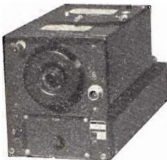
**BC-654** - Versione mod. R26 - ARC5 con medie a 1415 Kc freq. 3-6 Mc. Movimento a sintonia variabile adatto per conversioni e gamm. 3-6 impiega n. 6 valvole metalliche, n. 2 12SK7 - n. 1 12SR7 - n. 1 12A6 - n. 1 12K8-12SF7 ogni apparecchio è fornito di schema elettrico. Viene venduto privo di alimentazione.
