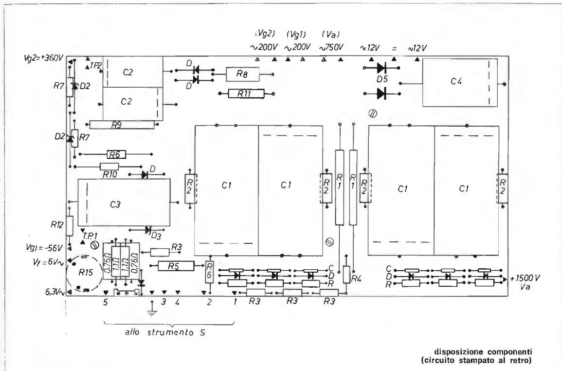
Onde aumentare l'affidabilità dell'apparato è utile porre in parallelo alla serie degli zener  $D_2$  un condensatore da  $0,1 \mu\text{F}$  500  $V_L$ , ceramico, onde evitare che qualche transitorio possa deteriorare gli zener stessi.
