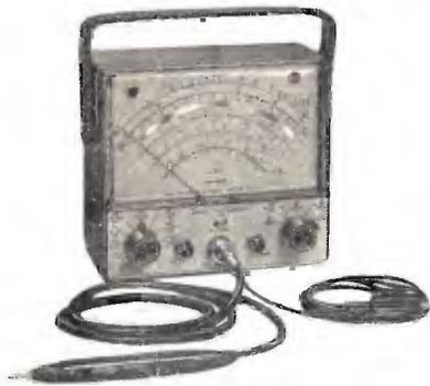
I **Voltohmysts** mod. **WV-500A** e mod. **WV-500B** sono strumenti con alimentazione a batteria completamente transistorizzati. Essi hanno le caratteristiche principali dei modelli « Senior Volt-ohmyst ». Il modello **WV-500B** permette anche la misura delle correnti (con collegamento diretto allo strumento indicatore).
