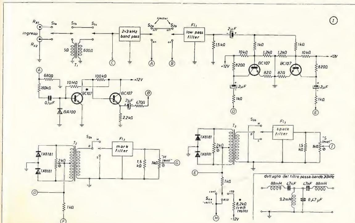
Segue un filtro passa basso con frequenza di taglio di 3 kHz, il quale, non lasciando transitare le componenti di Fourier superiori al primo ordine del segnale, presenta alla sua uscita una sinusoide pressoché indistorta e di ampiezza costante (con il limitatore inserito). Si ha quindi uno stadio separatore che pilota i due mixer bilanciati, la cui necessità è indiscutibile, soprattutto pensando alle frequenze dei due filtri di tono impiegati in questo prototipo.
