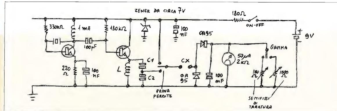
I transistor sono 2N706 o 708, o similari; bobina L e condensatori C<sub>1</sub> e C<sub>2</sub> vanno scelti, a seconda della frequenza, in proporzione ai miei.
