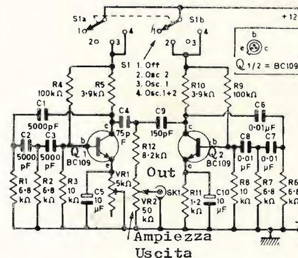
Il richiesto grado di rotazione di fase tra ingresso e uscita necessario ad assicurare stabili oscillazioni può essere ottenuto mediante un trasformatore usato come elemento di controreazione; ma controllare la frequenza con un trasformatore non è facile quindi lo si elimina ricorrendo a condensatori in serie, con altrettanti resistori che completano la rete RC.
