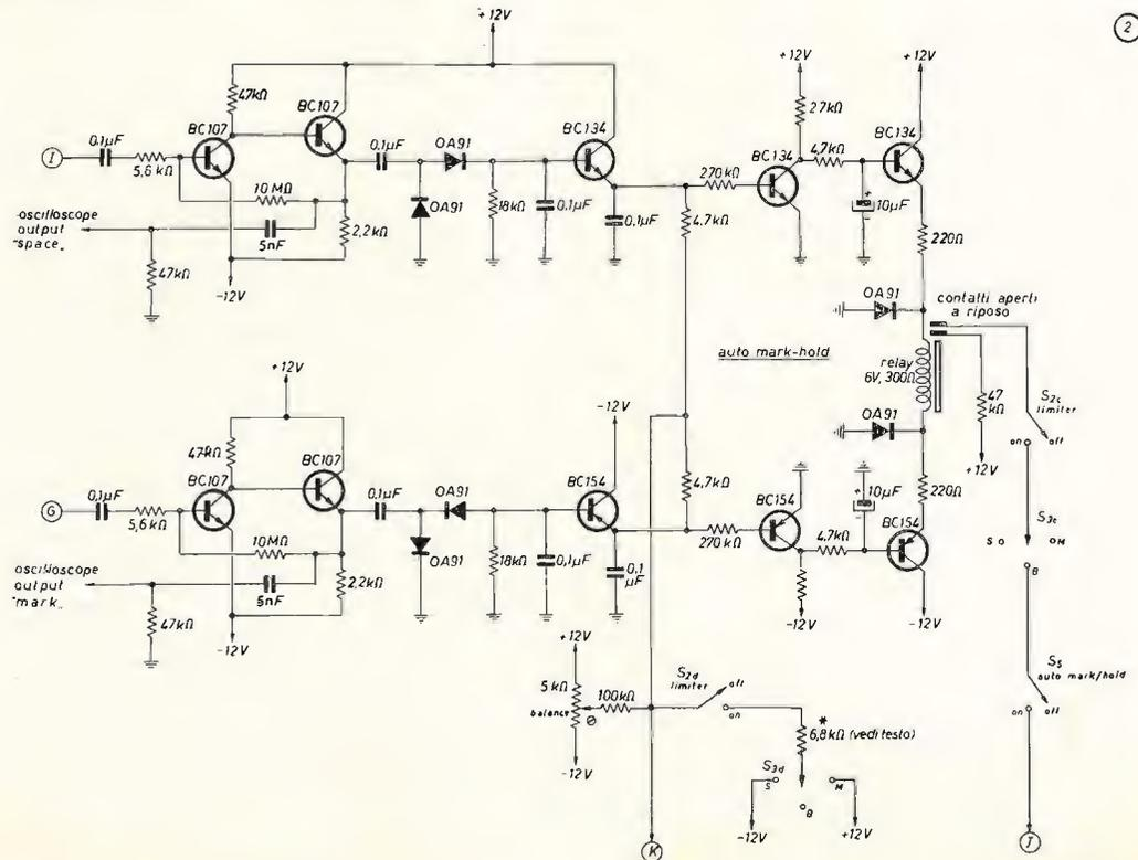
Il circuito appena descritto è altamente efficiente e costituisce senz'altro il cervello del demodulatore, ma come tale è un po' critico, quindi si sconsigliano vivamente sostituzioni di transistor o componenti rispetto ai tipi e valori riportati sullo schema (eccezion fatta per i diodi 1X8181 che possono essere rimpiazzati dai BA100).
