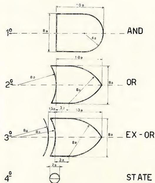
Ritengo di far cosa gradita ai lettori di **cq elettronica** che si interessano all'elettronica non lineare riportando le specifiche di disegno per circuiti porta (gate) così come descritte dalle norme MIL standard 806/B.
