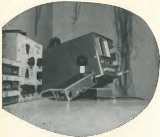
Il funzionamento si spiega da sé; basti ricordare che le regolazioni saranno facilitate dallo strumento incorporato, con cui i livelli alle varie frequenze possono essere misurati separatamente. Ultima nota: l'ampiezza dei segnali manipolabili è da 50 a 800 mV; più in giù si ha rumore, più in su distorsione.
