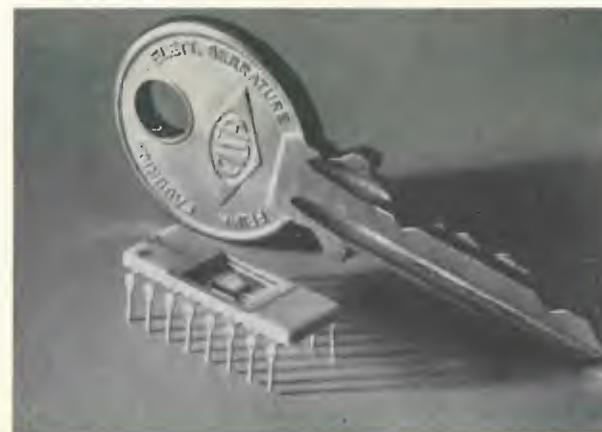
**Nuovi sistemi MOS/LSI della General Instrument Europe in grado di sostituire 126 circuiti tradizionali**
