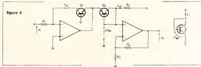
Nel nostro circuito interessano solo la  $I_c$  e la  $V_{BE}$ . Le altre grandezze ( $q$  = carica dell'elettrone,  $k$  = costante di Boltzmann,  $T$  = temperatura assoluta), le consideriamo costanti. Con una coppia di transistori si può scrivere:
