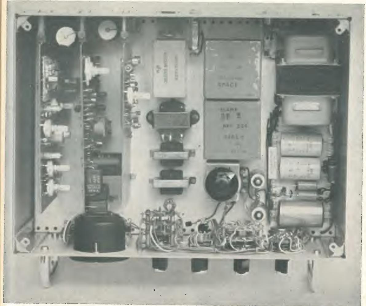
Il demodulatore visto dall'alto senza il pannello superiore
