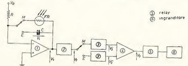
1 è un amplificatore operazionale usato come amplificatore a guadagno variabile in fase di « misura luce » e come integratore durante l'esposizione. Come misuratore della luce si ha:
