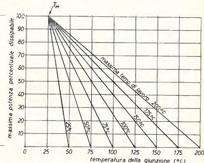
Faccio un esempio. Supponiamo di utilizzare come transistor il 2N174 (al germanio). Dai dati del costruttore abbiamo:  $P_0 = 150$  W,  $T_j = 100$  °C,  $R_t$  (transistor) = 0,5 °C. Supponendo di utilizzare un dissipatore termico avente una resistenza termica di 1,4 °C/W e di realizzare un buon contatto termico tra il transistor e il dissipatore stesso (che può corrispondere a 0,1 °C/W) avremo:
