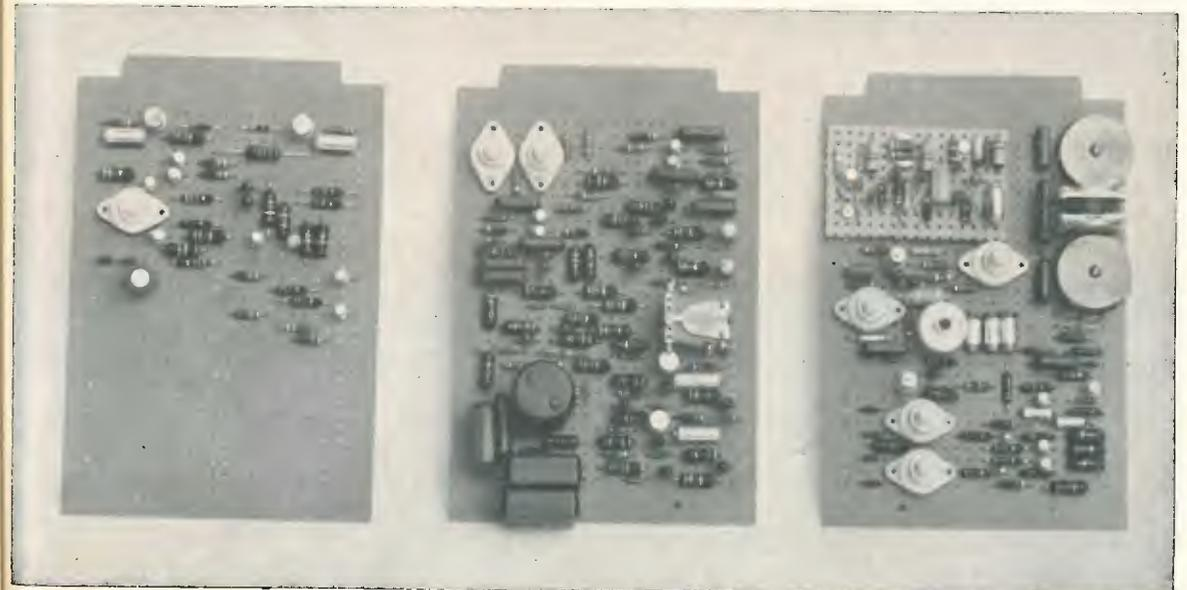
Il BC107 con asterisco sarà selezionato tra quelli acquistati per la costruzione in modo da avere un beta piuttosto basso, sull'ordine di 100 o poco più. Il filtro passa basso  $F_1$  è sostituibile con esemplare analogo eventualmente recuperato nel surplus, o autocostruito con celle Butterworth.
