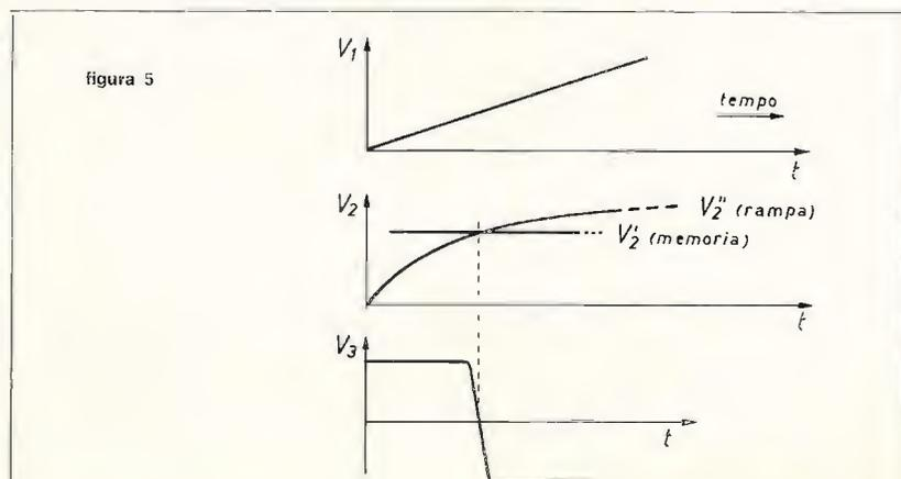
Il blocco 3 di memoria è semplicemente un FET con una forte capacità sul gate. Data la minima corrente assorbita dall'ingresso del FET (dell'ordine dei nA), il condensatore resta per molto tempo alla tensione a cui è stato caricato; il source-follower riporta tale tensione su una bassa impedenza all'ingresso del comparatore. 3' è un circuito identico a 3, ma senza condensatore e serve unicamente a simmetrizzare il circuito e compensare in parte le derive termiche della  $V_{gs}$ .
