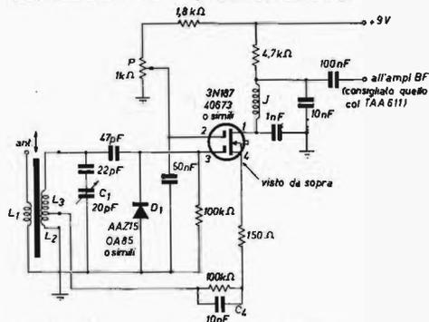
Esempio di bobina per i 7 MHz: Ø 6+8 mm per nucleo regolabile, filo da 0.2 mm smaltato.
