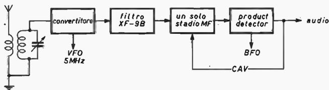
Il segnale a 14 MHz in arrivo viene subito convertito a 9 MHz, facendolo battere con un VFO a 5 MHz. Dopo essere passato attraverso il filtro a cristallo, il segnale viene amplificato in un solo stadio di MF e quindi rivelato. Più semplice di così!
