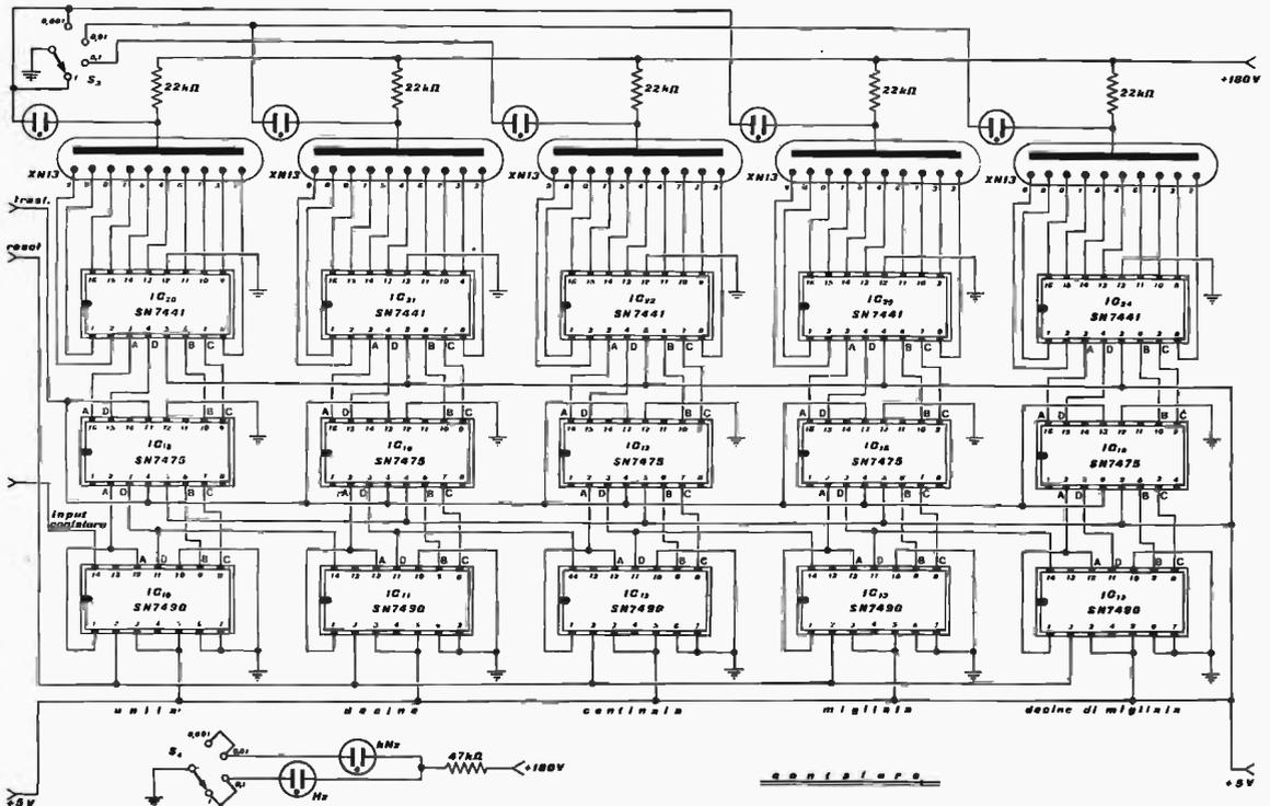
Come per il reset tutte le memorie hanno i comandi clock (pin 4 e 13) collegati con il dispositivo di trasferimento.
