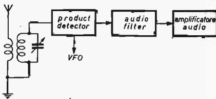
Il segnale in arrivo viene inviato subito al rivelatore, dopo essere passato attraverso un normale circuito accordato alla frequenza che si vuole ricevere. Al rivelatore giunge anche il segnale del VFO che, a differenza di una supereterodina, oscilla sulla stessa frequenza del segnale in arrivo. Dal battimento dei due segnali abbiamo il segnale audio.
