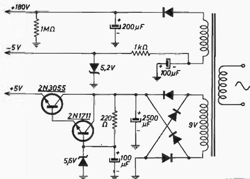
Un diodo e un elettrolitico forniscono i 180 volt positivi necessari per i digits e le lampadine al neon (a proposito di lampadine fare attenzione all'assorbimento, altrimenti si avranno i digits a illuminazione insufficiente). Sul braccio negativo viene prelevata, tramite un elettrolitico, una tensione di circa 14 V che con resistenza e zener viene ridotta a 5 volt negativi per lo stadio d'ingresso.
