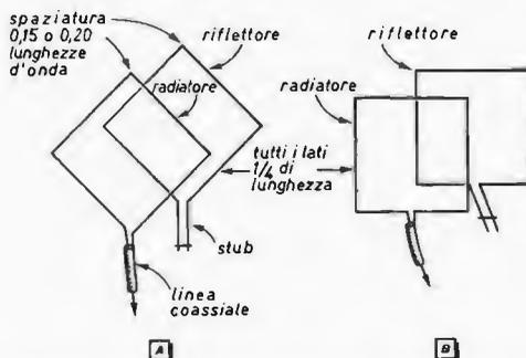
I conduttori radianti devono essere o in rame o in bronzo fosforoso, comunque di diametro non inferiore a 1,5 mm.
