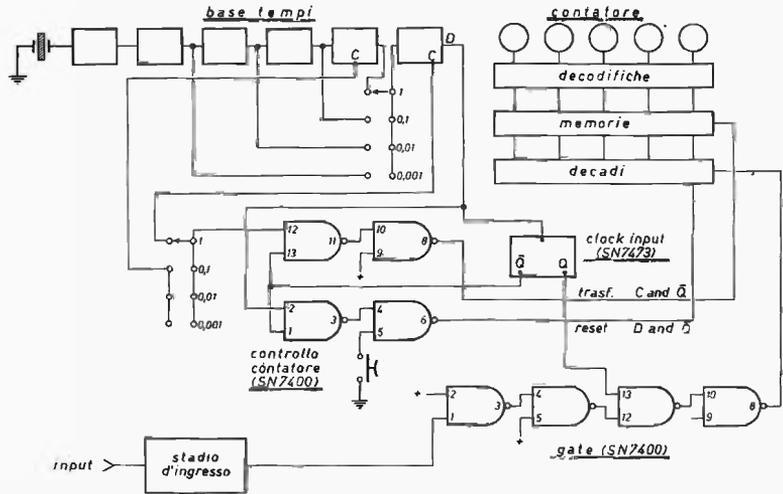
Il « clock input », sulla base del tempo preordinato, provvede ad abilitare il gate per il conteggio e conseguentemente a ordinare il trasferimento della cifra contata, dalle decadi di conteggio ai digits, facendo seguire al tutto l'azzeramento delle decadi per procedere quindi al ciclo successivo.
