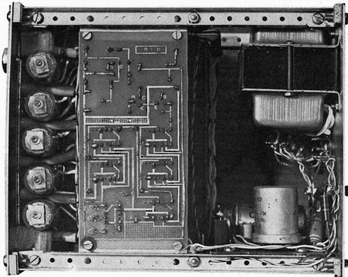
Vista superiore con una chiara esposizione del circuito della base tempi. Si notano chiaramente a fianco dei digits i tubetti che contengono le lampadine al neon per i punti di divisione decimale.
