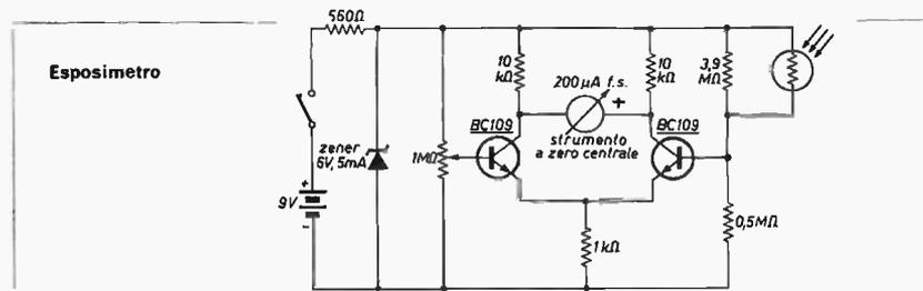
Lo schema è un volgarissimo ponte amplificato con stabilizzatore a zener contro gli abbassamenti di tensione dovuti alla scarica della pila.
