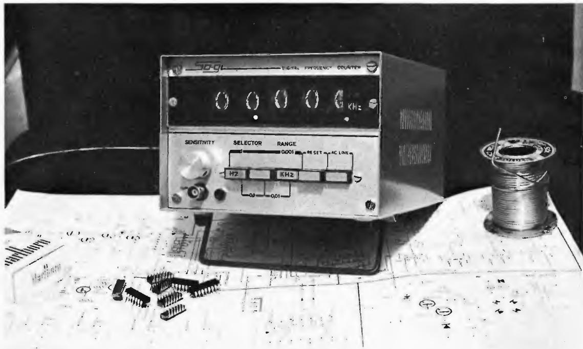
L'apertura e chiusura del gate viene realizzata da un complesso elettronico di sicuro affidamento che provvede anche all'azzeramento della cifra indicata e a preparare il contatore alla lettura successiva, in modo da permettere tutta una serie di letture diluite nel tempo, senza alcun intervento da parte dell'operatore.
