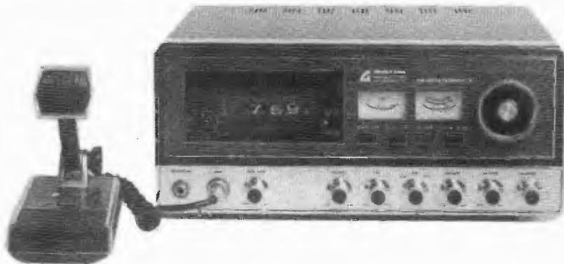
Il SIMBA SSB, la Stazione Base più professionale sui 27 MHz, opera in 23 canali AM e 46 canali SSB, il più moderno e perfezionato sistema di modulazione. La sensibilità migliore di  $0,2 \mu V$  e la grande potenza che in SSB raggiunge i 18 W P.E.P. ne fanno un apparato unico, con i numerosi dispositivi di serie, quali: controllo automatico di modulazione al 100 %, con strumento indicatore della percen-
