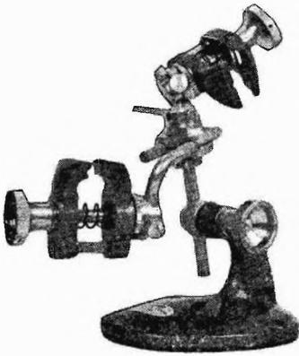
Si tratta di una coppia di morsetti, disposti a 90° e montati su due assi differenti, orientabili a piacere, agendo su viti zigrinate (come gli strumenti ottici). I morsetti possono ruotare individualmente di 360°, possono anche essere distaccati dai supporti, per usi vari. Il sistema è montato su una pesante base da tavolo, con snodi meccanici di buona precisione.
