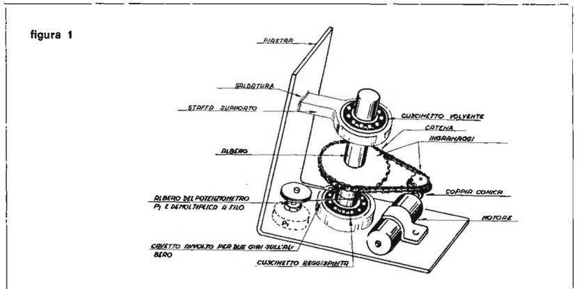
Per la trasmissione del moto al palo che sostiene l'antenna mi sono servito di una catena e due ingranaggi. Uno di questi (il più piccolo) è stato saldato sull'albero del motore, l'altro invece a un tubo di ferro lungo 30 cm e di diametro interno leggermente superiore al palo dell'antenna.
