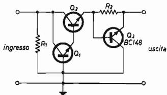
**1 - Un fusibile elettronico** - Quando si tratta di parti di alimentazione destinate a prove di prototipi o di modelli, è importante proteggerle con un dispositivo limitatore di corrente o da un « fusibile » elettronico.
