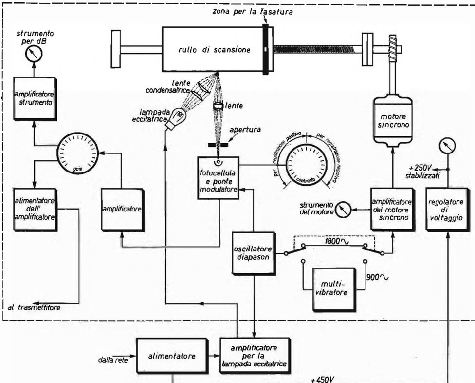
Nella figura 1 è riprodotto il trasmettitore. Su un rullo che ha due moti, e cioè di rotazione e di traslazione, viene avvolta l'immagine da trasmettere. Una lampada illumina una piccola superficie dell'immagine che si vuole trasmettere e la luce riflessa agisce su una fotocellula inclusa in un ponte determinando una modulazione.
