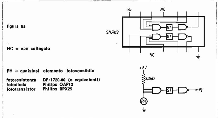
Ecco perché il dispositivo di figura 8 può funzionare, ma è critico nel senso che bisogna usare proprio quei due componenti, in quanto un'altra LDR con *recovery rate* diversa può rivelarsi non adatta. Ma niente paura, fatta la legge trovato l'inganno, dicevano i saggi, per cui volendo usare una LDR diversa o qualsiasi altro dispositivo fotosensibile (fotodiodo o fototransistor) si può usare lo schema di figura 8a che impiega appunto un SN7413 (*dual nand Schmitt triggers*).
