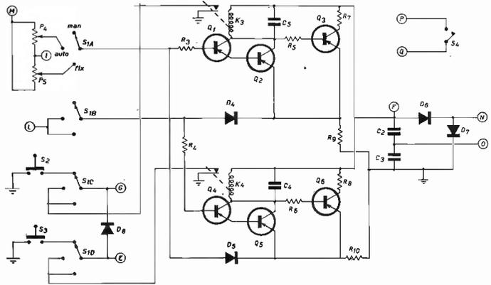
Se poi poniamo il commutatore in posizione « fix » al posto del potenziometro  $P_4$  viene collegato il trimmer  $P_3$  che provocherà la rotazione fino alla posizione prefissata dall'operatore all'atto della taratura.
