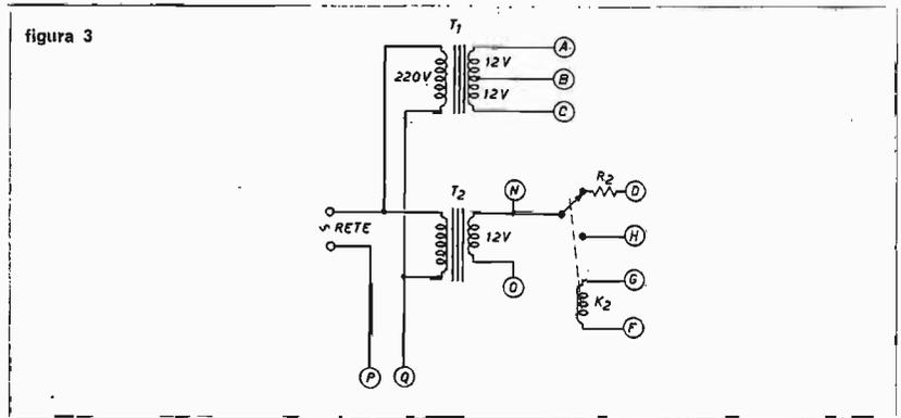
Il relay  $K_2$ , quando eccitato, fornisce l'alimentazione al motore, in caso contrario accende una lampadina che illumina la scala del microamperometro indicatore di direzione nella control-box.
