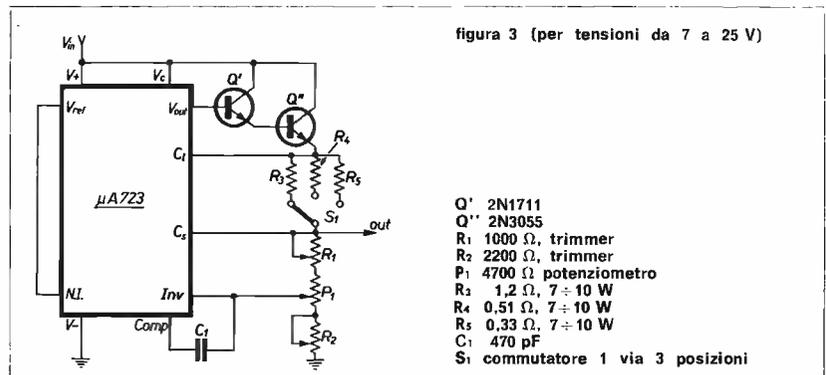
La modifica più importante è, però, quella che ci permette di ottenere anche le tensioni inferiori ai 7 V, e più precisamente da 2 a 7 V, usando gli stessi elementi del circuito di figura 3 mediante un sistema di commutatori.
