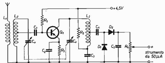
I supporti delle bobine devono avere un diametro di 8 mm con nucleo in ferrite regolabile.
