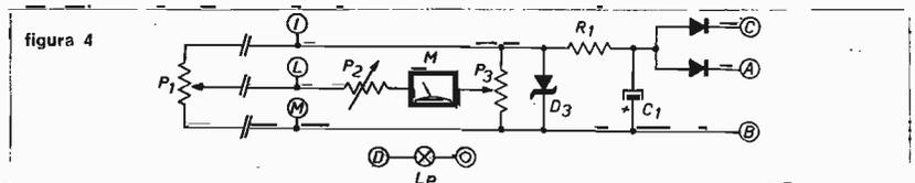
L'alimentazione è stabilizzata a 9,1 V dallo zener: questo si è reso necessario per avere indicazioni non affette dall'errore dovuto a variazioni di tensione sul primario del trasformatore di alimentazione.
