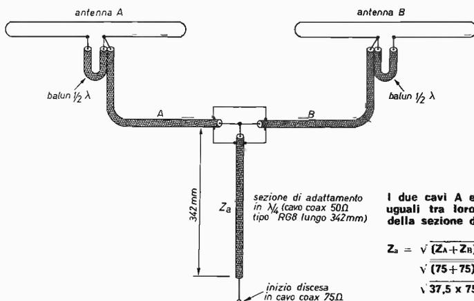
I due cavi A e B possono essere di lunghezza qualsiasi purché uguali tra loro e la loro impedenza di 75 Ω. L'impedenza  $Z_a$  della sezione di adattamento in quarto d'onda si calcola così:
