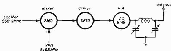
Per ottenere gli 80 metri basta accordare l'uscita del mixer a 3,5 MHz e si avrà all'uscita un segnale a 3,5 MHz ( $9 - 5,5 = 3,5$ ).
