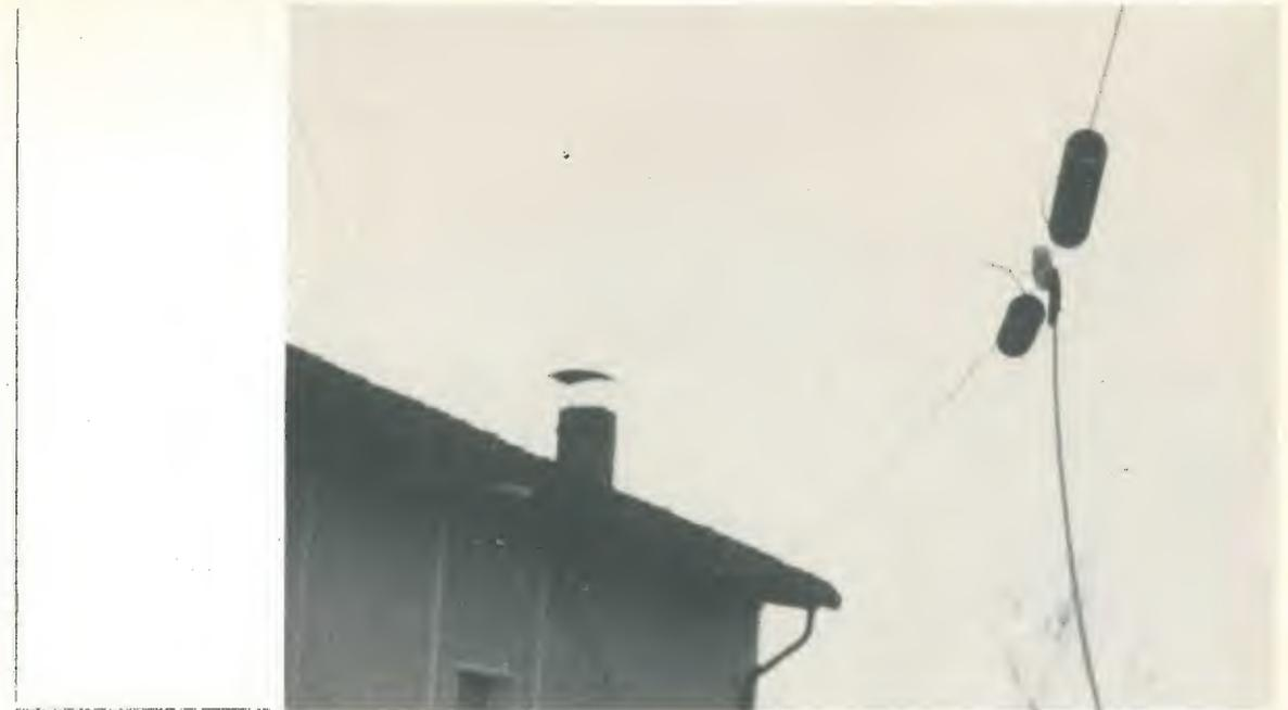
Le due bobine, identiche, sono formate da 54 spire unite di treccia di rame da 1,6 mm ricoperta in plastica (noi abbiamo usato il cavo da 1,6 di Fantini, quello verde), avvolte su di un supporto cilindrico di plastica del diametro di 4 cm. Questi supporti è bene che siano leggeri, altrimenti rischiate di vedere il vostro capolavoro in terra. Due ponticelli di filo dello stesso tipo serviranno a mettere in corto un po' di spire per portare in gamma il tutto.
