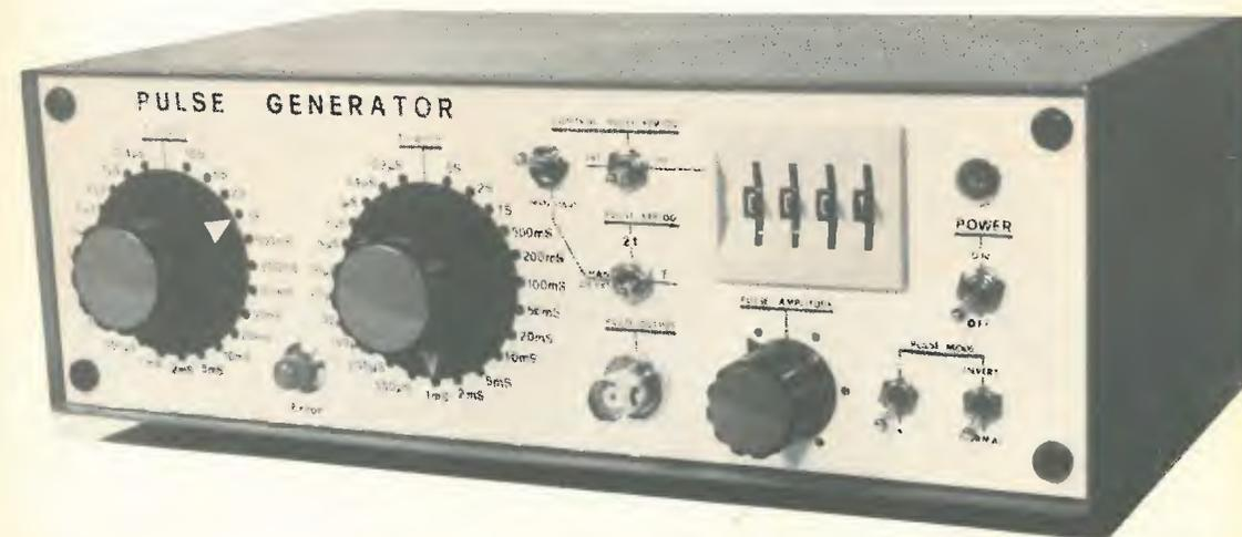
L'ampia variazione in ampiezza del segnale disponibile, unita alla doppia polarità, permette il collegamento con le varie logiche: DTL, TTL, HLL e MOS.
