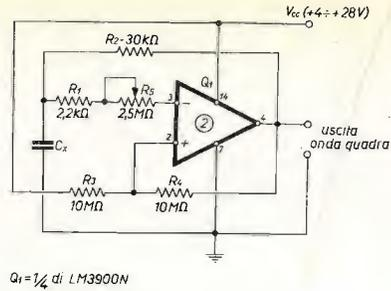
La resistenza variabile  $R_5$  ha la funzione di variare i tempi  $T_1$  e  $T_2$  (figura 3) in modo che  $T_1 + T_2$  rimanga costante. La regolazione di  $R_5$  permette di ottenere un'onda perfettamente simmetrica e in una realizzazione pratica  $R_5$  dovrebbe essere una resistenza variabile semifissa. La foto riportata illustra chiaramente un semplice assemblaggio dei componenti che è comodo in una fase sperimentale della realizzazione del generatore d'onde quadre.
