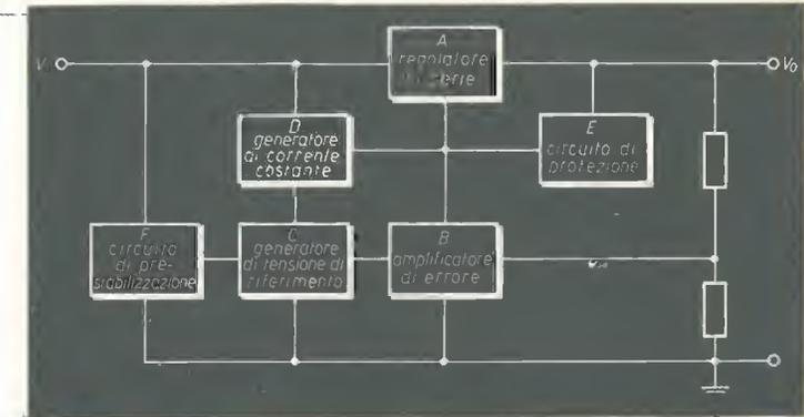
A titolo puramente informativo in figura 1 è riportato lo schema a blocchi del circuito integrato che comprende sia i circuiti di stabilizzazione che i circuiti di protezione contro i cortocircuiti. L'unità di regolazione è del tipo in serie ed è costituita da un circuito Darlington (vedi figura 2) di potenza. Ciò permette l'utilizzazione del circuito integrato direttamente senza bisogno di unità di potenza accessorie fino a correnti di erogazione di tutto rispetto.
