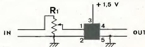
In più ci sarebbe un potenziometro, se volete anche regolatore di volume, e che potete sostituire con uno semifisso per risparmiare un tre o quattrocento lire, poche ma sufficienti a comprarvi gli altri componenti. L'alimentazione potete ricavarla da una semplice pila a stilo e se credete potete elevare la tensione di alimentazione fino a 4,5 V: aumenterà l'amplificazione (conseguentemente anche il consumo).
