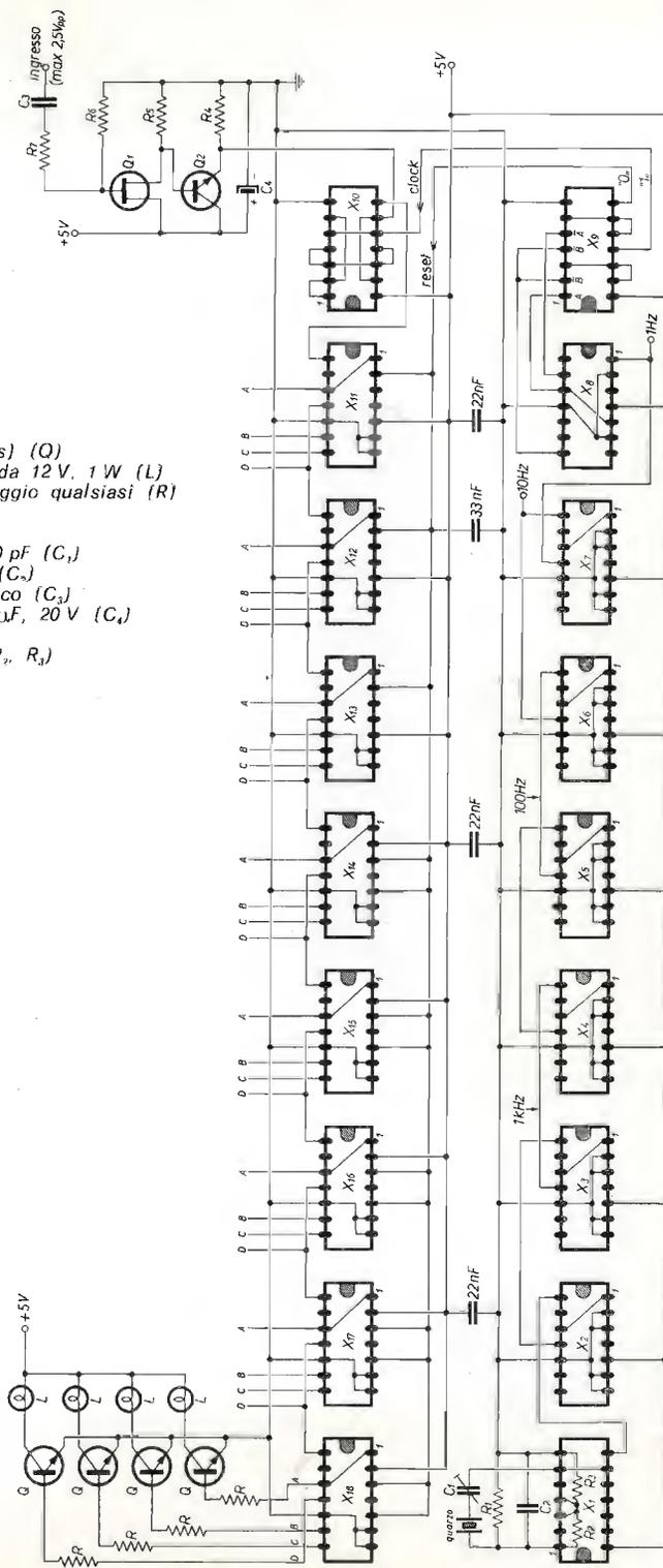
In totale vengono impiegati trentadue transistor e trentadue lampade in me di quattro. Le quattro lampade di ciascuna fila hanno un peso decimale rispettivamente di 8 per l'uscita D, 4 per l'uscita C, 2 per l'uscita B e 1 per l'uscita A di ciascuna decade. Per leggere la frequenza misurata è perciò necessario fare la somma a mente. Per esempio, se in una fila si illuminano la cifra 8 e la cifra 1, avremo il numero decimale 9; se si illuminano il 4 e il 2, avremo il numero decimale 6, e così via.
