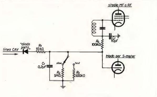
La figura 1 rappresenta lo schema di principio di un CAV con le summenzionate caratteristiche: attacco rapido e due tempi di scarica. Si vede che il diodo è stato collegato in maniera che la tensione negativa del CAV può fluire solo nel senso indicato dalla freccia e non viceversa.
