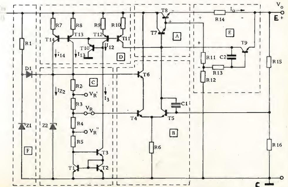
Schema elettrico dettagliato del circuito integrato costituente l'alimentatore stabilizzato L005/L036/L037.
