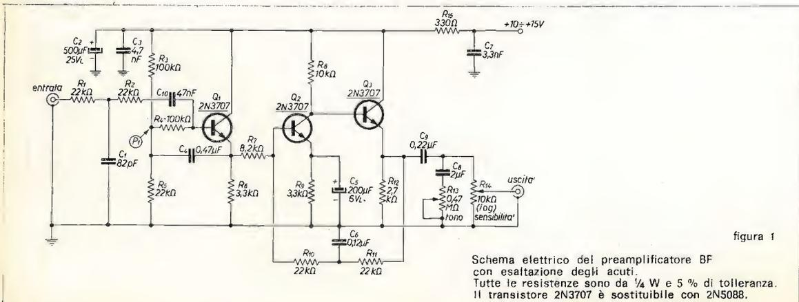
Si tratta di un amplificatore a tre stadi collegati tra loro ad accoppiamento diretto in cui la regolazione della sensibilità viene ottenuta lasciando costante il guadagno del preamplificatore e regolando semplicemente il livello del segnale di uscita. Ciò è stato fatto per minimizzare gli eventuali effetti microfonici del potenziometro  $R_{10}$  e per ridurre il ronzio captabile dai cavi di collegamento del potenziometro stesso.
