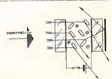
Il consumo di corrente di un cristallo liquido è di circa  $20 \div 30 \mu\text{A}/\text{cm}^2$  con tensioni di  $12 \div 13\text{V}$ , in alcuni displais per orologi si sono ottenute correnti di  $6 \mu\text{A}/\text{cm}^2$ .
