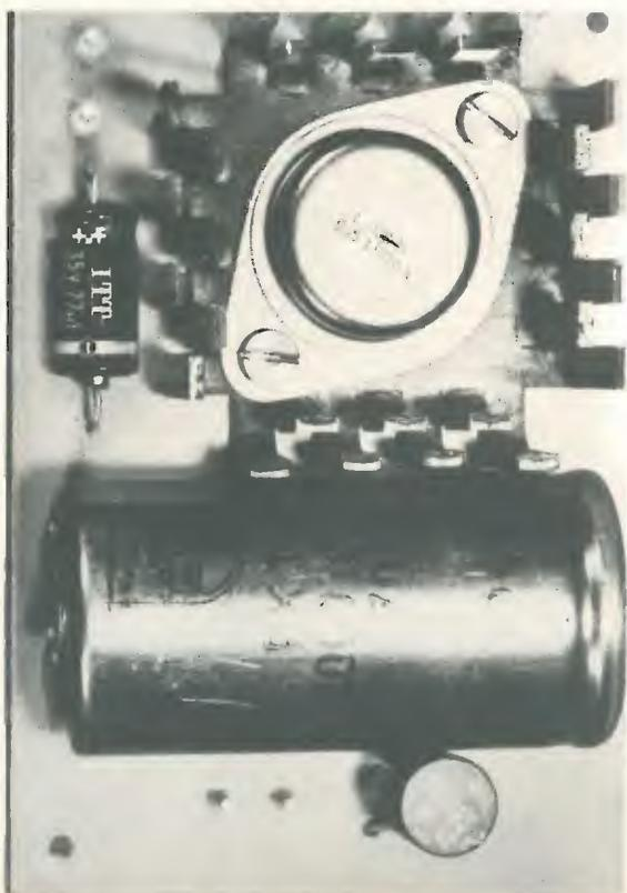
L'alimentatore stabilizzato il cui aspetto esterno (vedi fotografia) è assolutamente uguale a quello di un transistor in contenitore TO-3 può fornire le seguenti tensioni stabilizzate:
