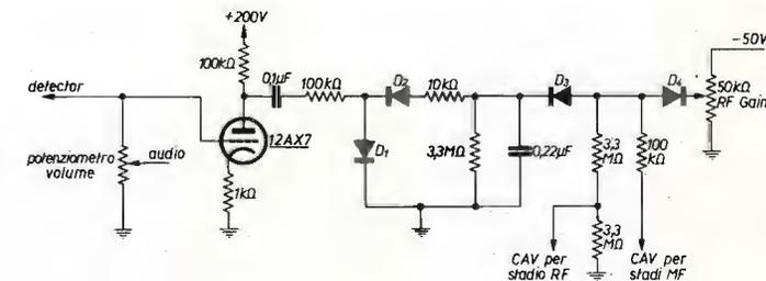
Sulla placca del triodo il segnale audio amplificato viene rettificato da due diodi al silicio  $D_1$  e  $D_2$ , montati come duplicatori di tensione. Le due resistenze da 10 kΩ e da 3,3 MΩ e il capacitore da 0,22 μF forniscono un attacco rapido e una scarica lenta.
