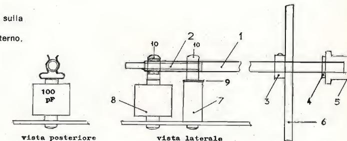
Una delle viti fissa il condensatore a massa. Sulla parte superiore viene fissata una speciale molletta doppia, sagomata in modo da abbracciare un tubo di rame del diametro di 6 mm. Tali mollette sono reperibili dalla GBC col numero di catalogo GA-4150. Una seconda molletta viene montata su di un colonnino in plexiglass  $\varnothing$  10 mm e della stessa altezza (meno lo spessore del nastro di collegamento) del condensatore ceramico.
