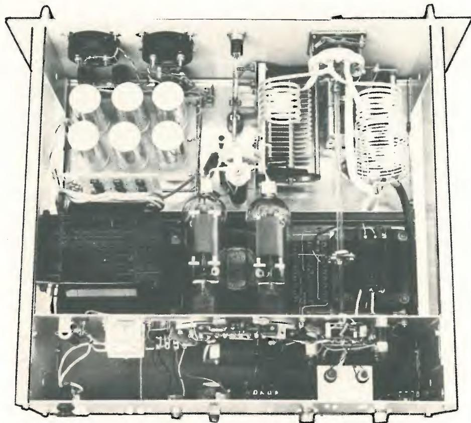
Il telaio RDT consiste in due fiancate e due pannelli (fronte e retro). Inoltre è possibile avere un divisorio verticale (sul quale sono fissati gli zoccoli dei tubi). Un telaio di alluminio appositamente costruito serve di appoggio ai variabili e alle altre parti sul fronte del telaio, mentre due sostegni di sezione a L sorreggono il trasformatore AT, il ventilatore, una basetta con alcuni componenti e il trasformatore dei filamenti.
